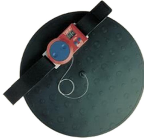
izim 3.1. Dikey sırama lümü yapan jumpmetre cihazı
