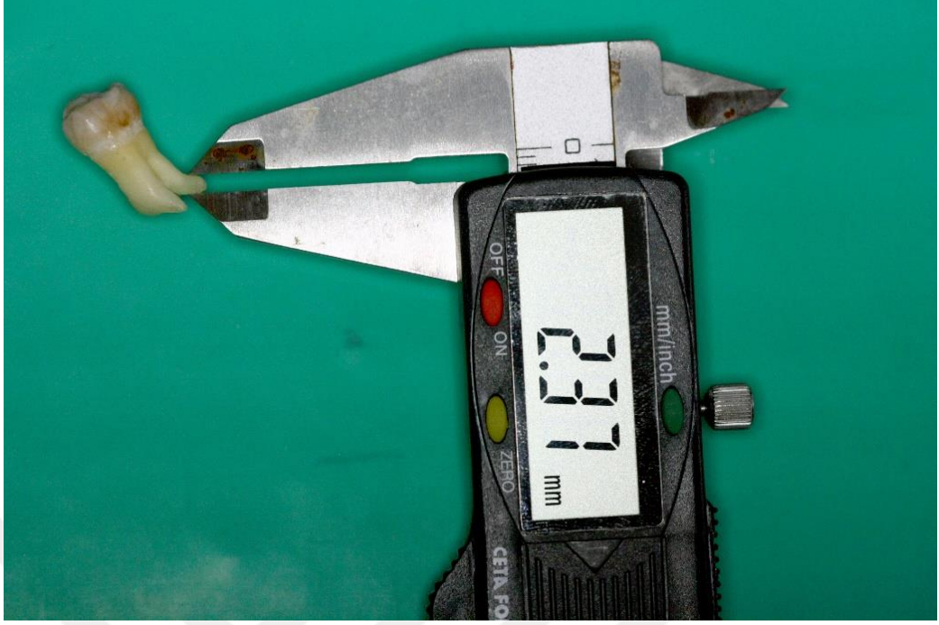
Şekil 3. Kökün apikal üçlüdeki kalınlığının elektronik kumpasla ölçümü.
