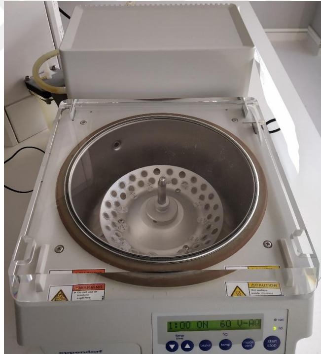
Şekil 3.8. Örneklerin Speed-Vac cihazı ile kurutulması.
