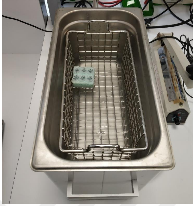
Şekil 3.9. Sonik banyo uygulaması ile sıvıdaki baloncukların uzaklaştırılması.
