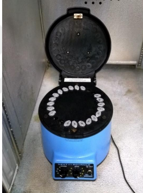
Şekil 3.4. Bakterilerin bullet blender cihazında +4°C’de çelik boncuklar ile parçalanması.
