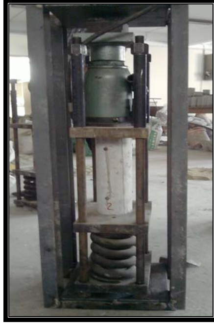
Şekil 3.15. Yükleme çerçevesi olarak hazırlanan düzenek
