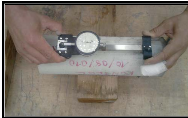
Şekil 3.16. Rötre numunelerinin ölçülmesi
