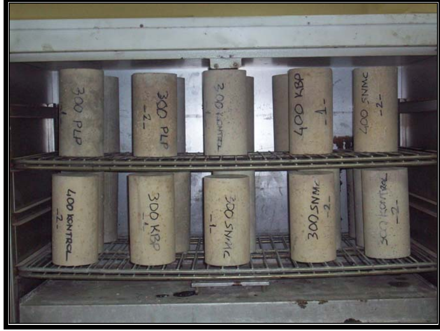
Şekil 3.10. Dona dayanım deney numunelerinin etüvde kurutulması
