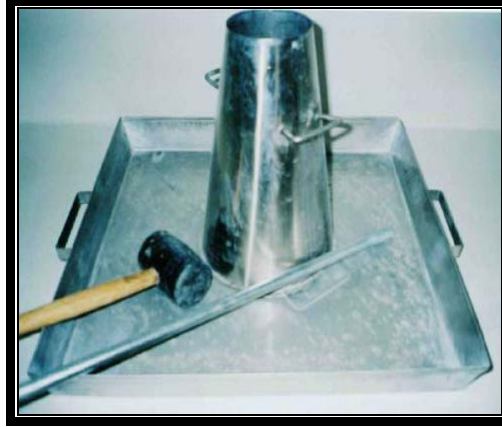
Şekil 3.6. Deneyde kullanılan çökme hunisi
