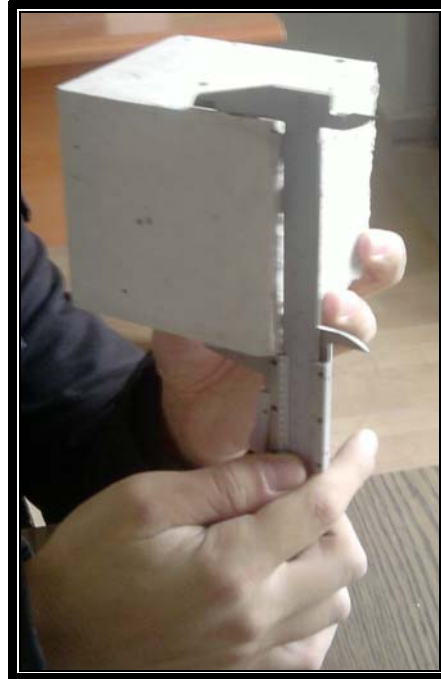
Şekil 3.7. Kuru birim hacim ağırlıkları hesaplanan numuneler
