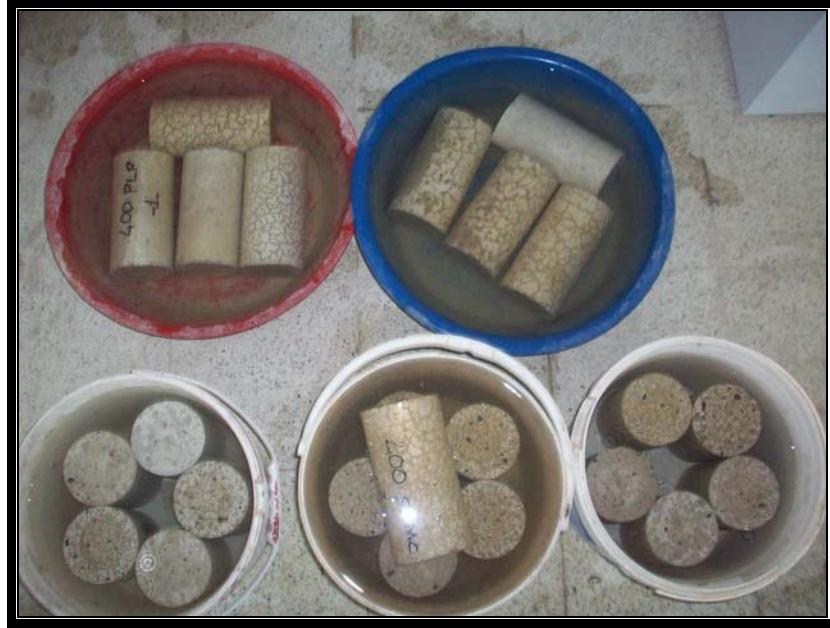
Şekil 3.12. Su içerisinde kür edilen numuneler
