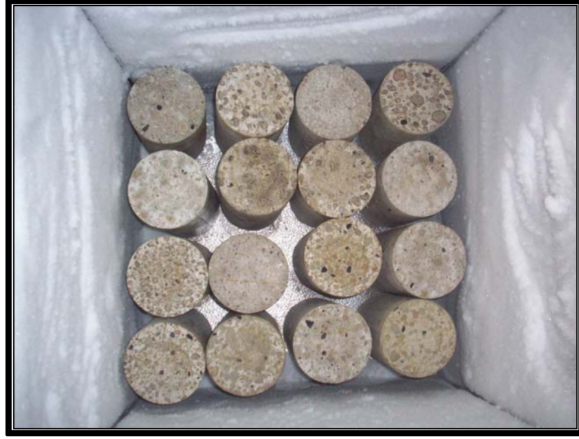
Şekil 3.11. Derin dondurucuda dondurulan numuneler
