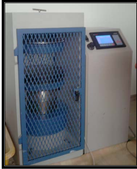
Şekil 3.8. Deneyde kullanılan tek eksenli basınç test cihazı
