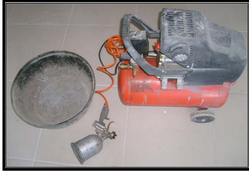
Şekil 3.3. Kompresör ve üstten hazneli boya tabancalı sistem
