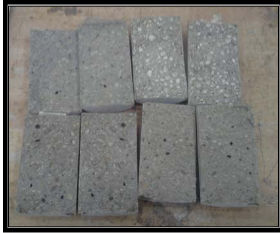
Şekil 3.9. Yarmada çekme deneyi sonucu numune görüntüleri
