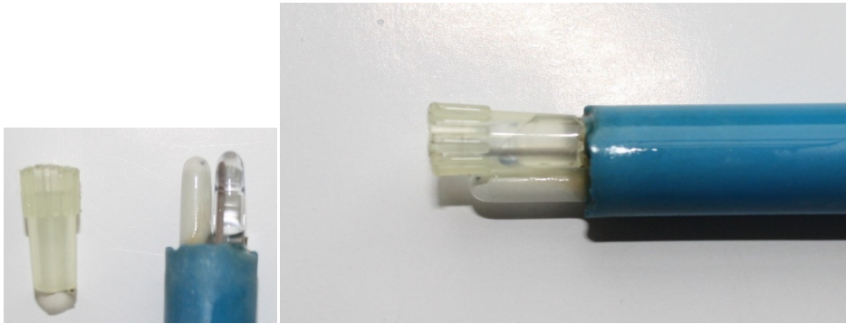
Şekil 3.1. Hazırlanan mikropipet ucu takılı elektrot
