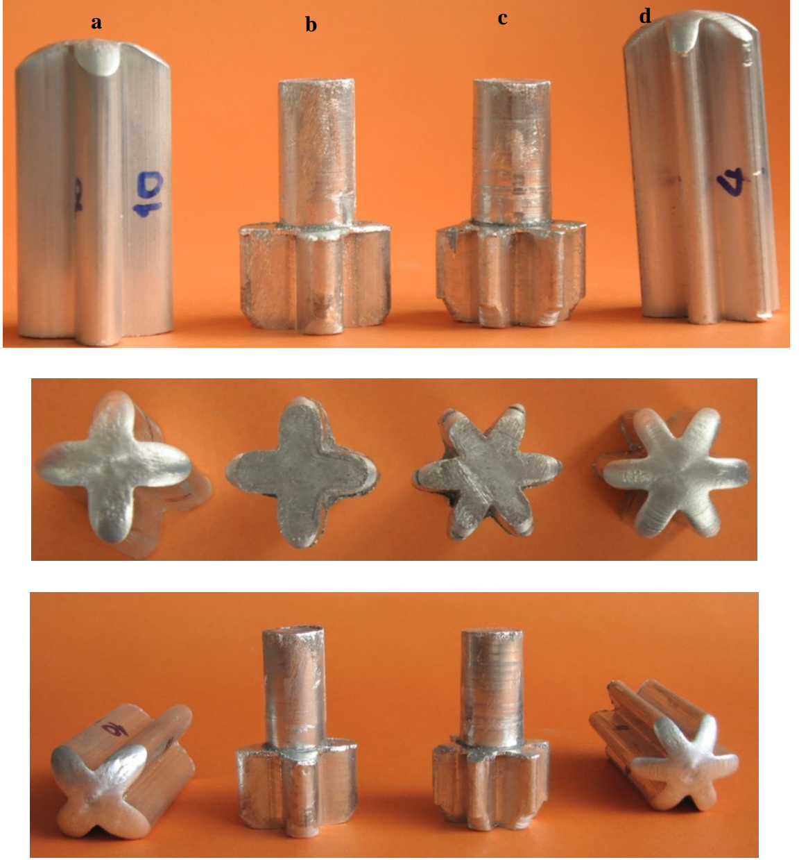
Şekil 7.2. Ürünler Görünüm: a) 4diş ileri ekstrüzyon, b) 4diş radyal ekstrüzyon, c) 6diş radyal ekstrüzyon, d) 6diş ileri ekstrüzyon
