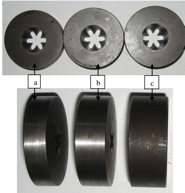
Şekil 4.8. 6 dişli parçalar için Cosinus Profil Kalıpları a) L=15, b) L=20, c) L=25
