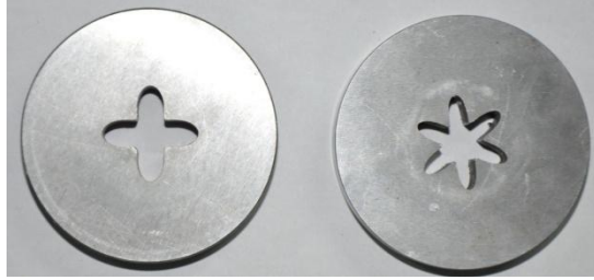
Şekil 4.12. 4 ve 6 dişli Radyal Ekstrüzyon Kalıpları a-) 4 dişli, b-) 6 dişli
