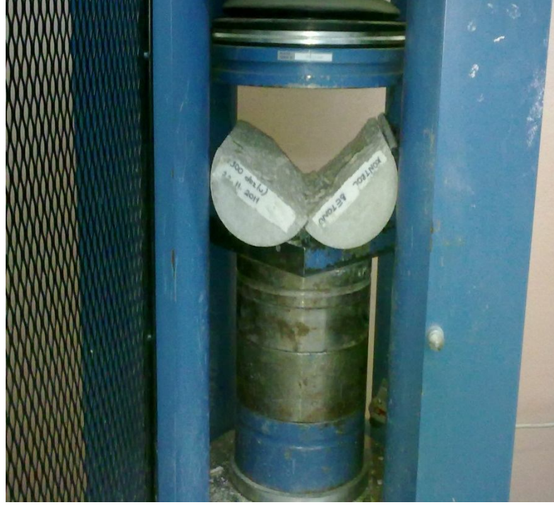
Şekil 4.3. Numunenin pres tablasına yerleştirilmesi
