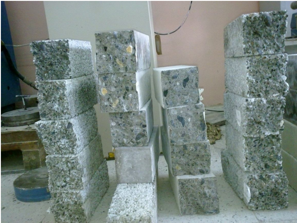
Şekil 4.9. Eğilmede çekme dayanımı deneyi sonrası numuneler
