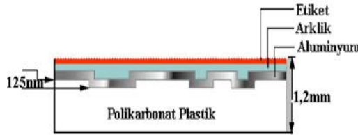
Şekil 15. Veri kaydı yapılmış CD-ROM'un malzeme yapısı
