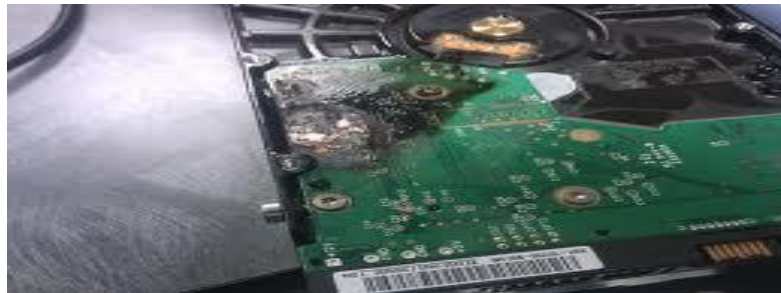
Şekil 33. Yanmış sabit disk devre kartı
