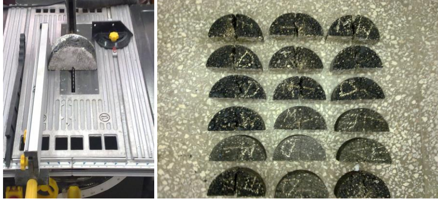
Şekil 5.64. Numunelere çentik açılması ve deney numuneleri
