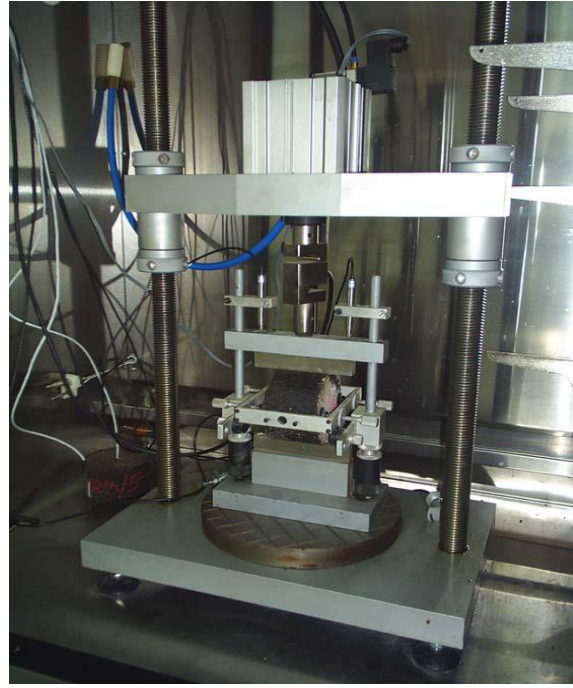
Şekil 4.21. Yorulma deney düzeneği
