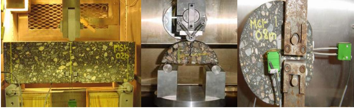
Şekil 4.25. Kırılma deneylerinde en çok kullanılan deney geometrileri (a) tek çentikli kiriş eğilme deneyi (b) yarım daire eğilme deneyi (c) disk şeklinde numune çekme deneyi [120]
