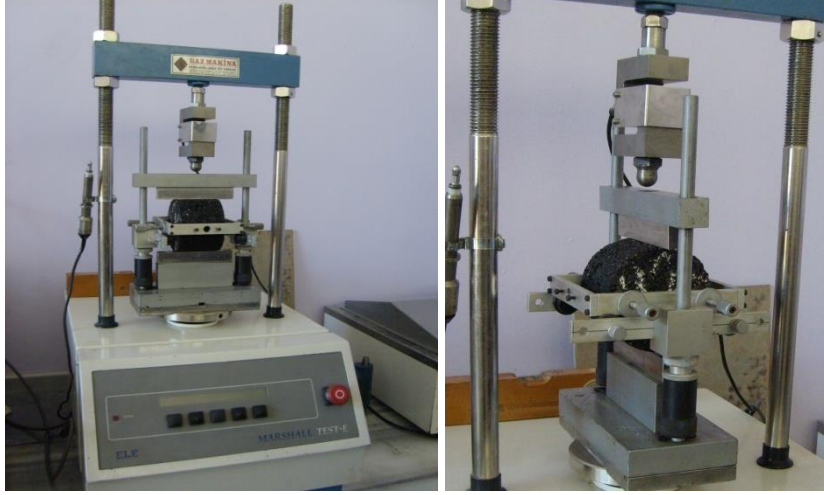
Şekil 4.18. Çekme dayanımı deney düzeneği
