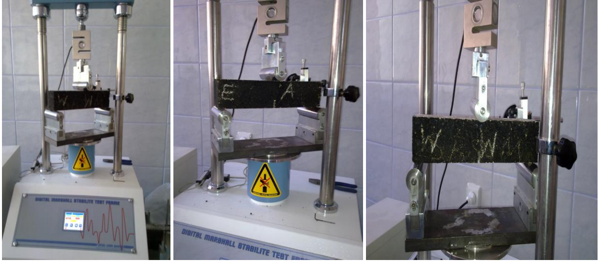
Şekil 5.75. Üç nokta kiriş eğilme deney düzeneği ve deneye tabi tutulmuş numuneler
