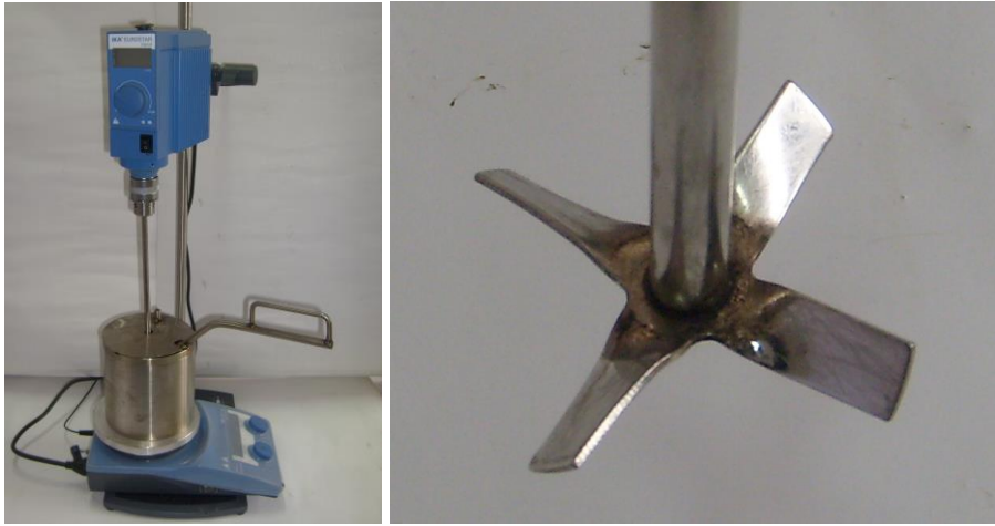
Şekil 5.3. Modifiye bitüm mikseri ve karıştırma başlığı
