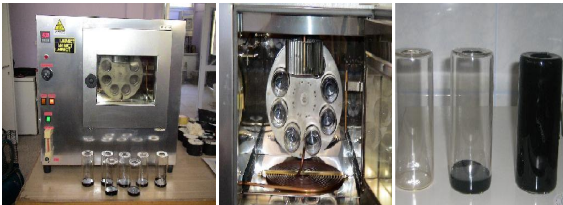
Şekil 4.3. Dönel ince film halinde ısıtma deney aleti
