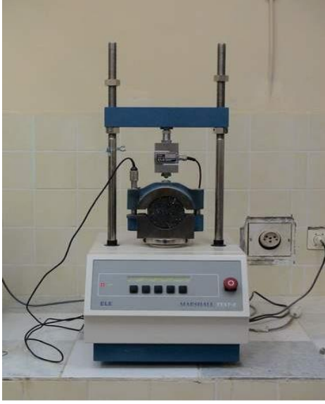
Şekil 4.16. Marshall stabilite ve akma aleti
