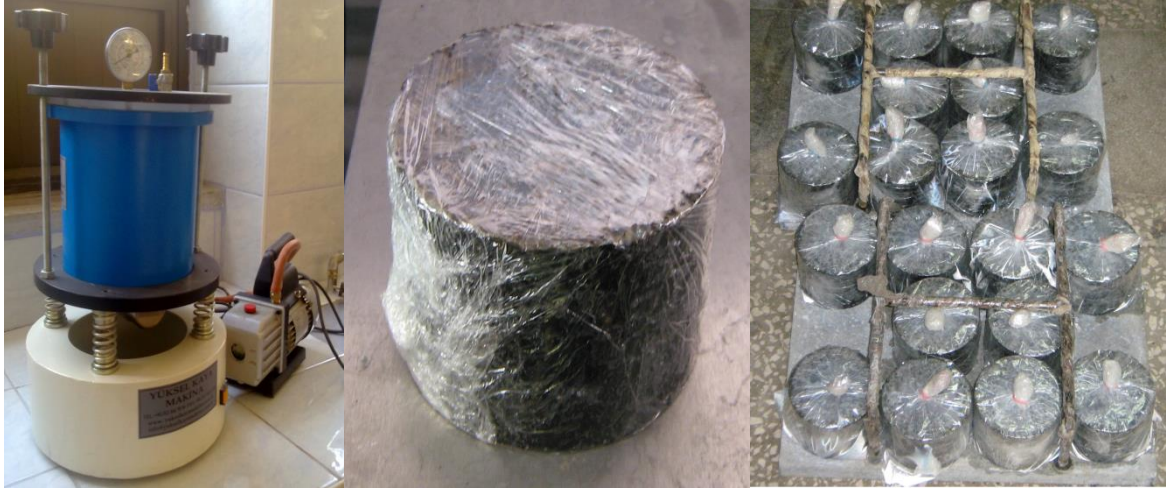
Şekil 4.17. Piknometre ve vakum cihazı, numunelerin koşullandırma işlemi için hazırlanması
