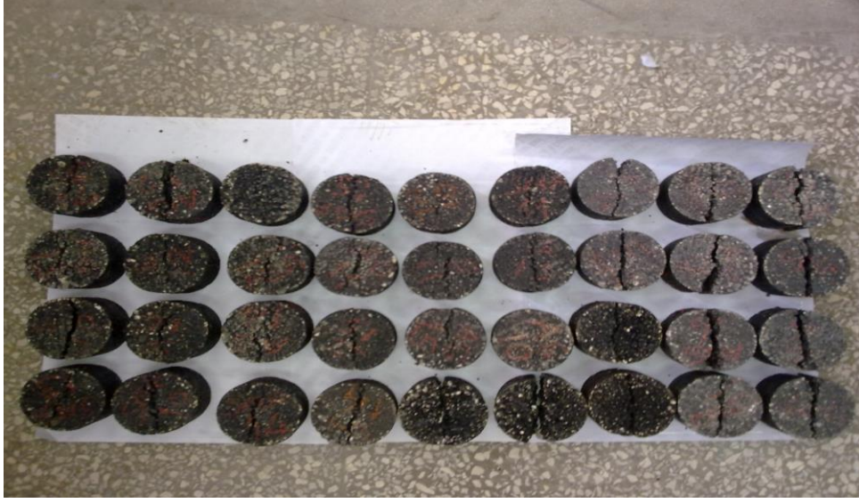
Şekil 5.50. Yorulma deneyi sonrasında numunelerin görünüşü
