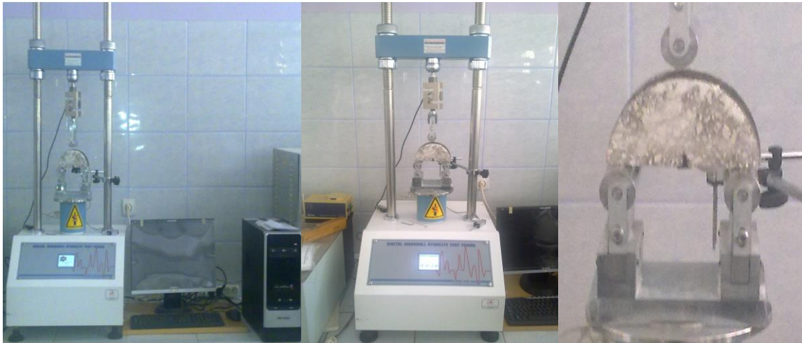
Şekil 5.65. Yarım daire eğilme deney düzeneği
