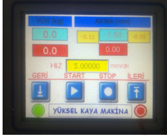
Şekil 5.66. Hızı ayarlanabilir marshall cihazının dijital göstergesi
