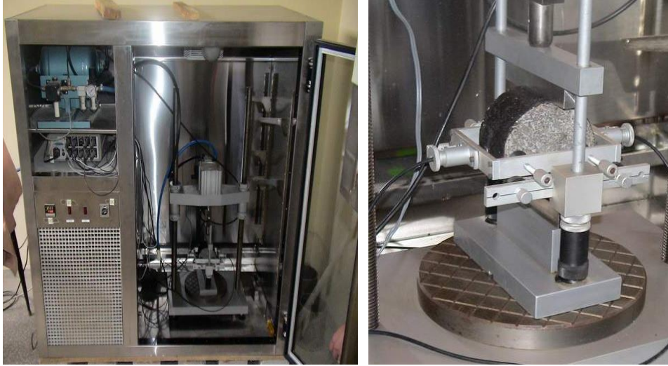
Şekil 4.20. ITSM deney düzeneği
