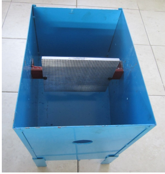
Şekil 3.16. Fındık kırma haznesi ve çarpma levhası
