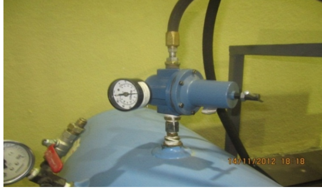
Şekil 3.10. Hava basınç regülatörü genel görünümü
