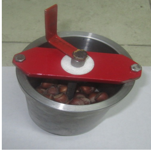
Şekil 3.15. Fındık karıştırma düzenegi üstten görünüşü
