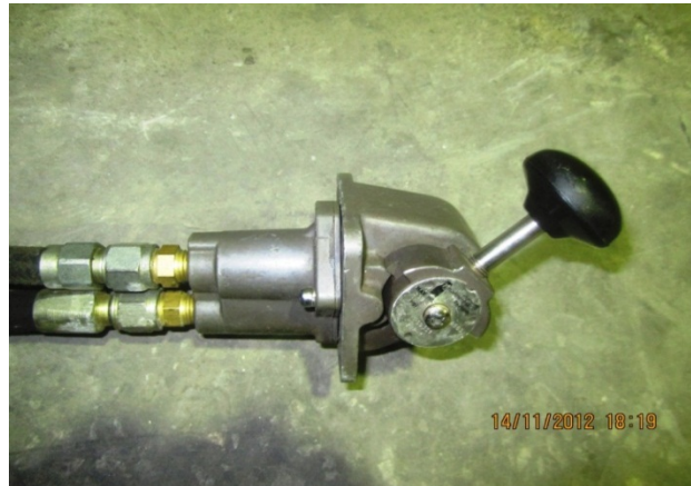
Şekil 3.11. Hava açma vanası
