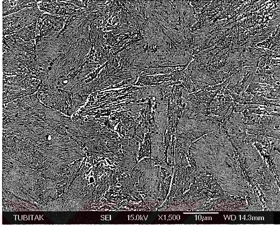
Şekil 7.9. H900 ısıt işlemleri sonrası elde edilen martenzitik iç yapının SEM fotoğrafı
