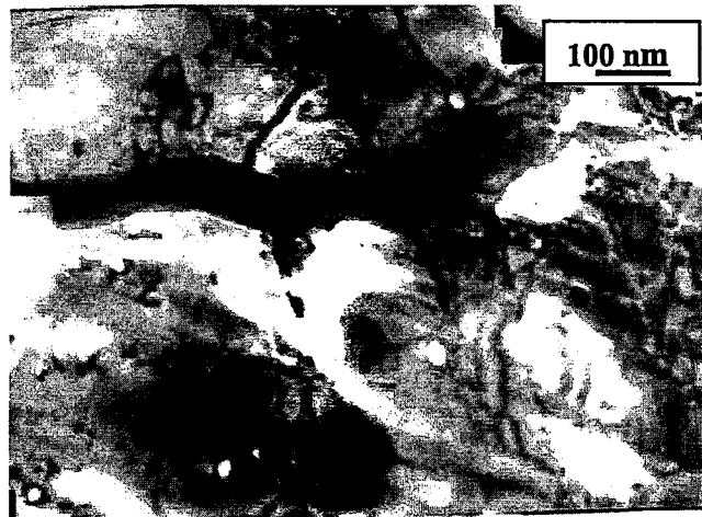
Şekil 7.27. 17-4PH malzemenin H1150 ısıtılması numunedeki Cu çökeltilerinin TEM fotoğrafı
