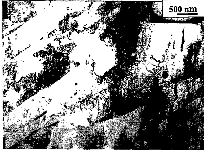
Şekil 7.29. 17-4PH malzemenin H450 ısıl işlemi sonrası elde edilen genel plaka martenzit ve dislokasyon yapısı TEM fotoğrafı
