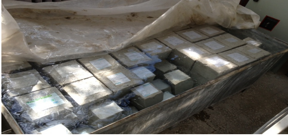
Şekil 4.5 Beton numunelere kür uygulanması
