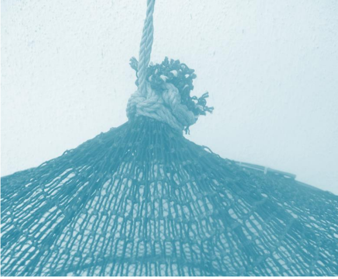
Şekil 3.17. Luvarların alt kısmının halatla bağlanması
