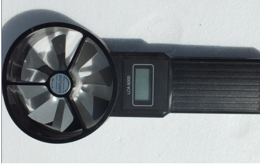
Şekil 2.1. Anemometre (rüzgar hızı ölçüm cihazı)
