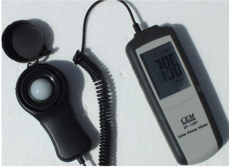
Şekil 2.2. Solarmetre (güneş ışınım ölçüm cihazı)
