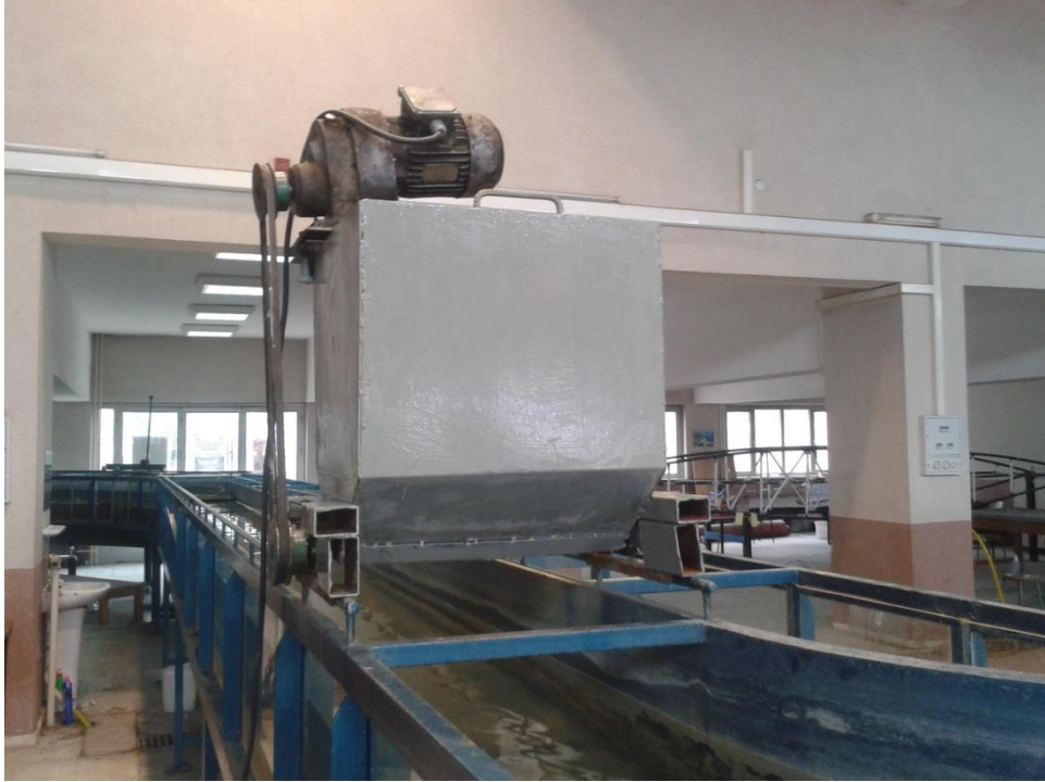
Şekil 5.12. Kanala katı madde ilavesi yapan portatif makine
