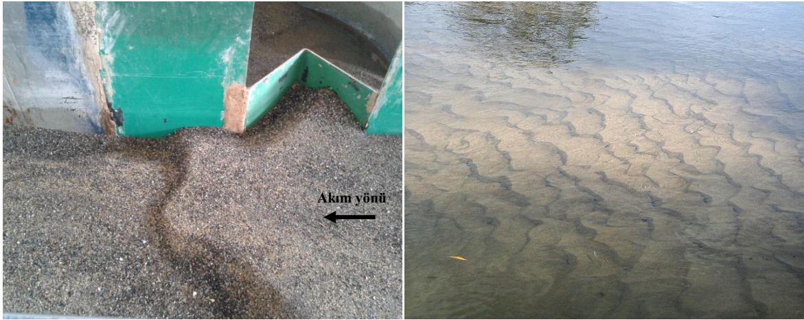
Şekil 4.8. Hareketli bir tabanda oluşan dalgacıklar (ripple)
