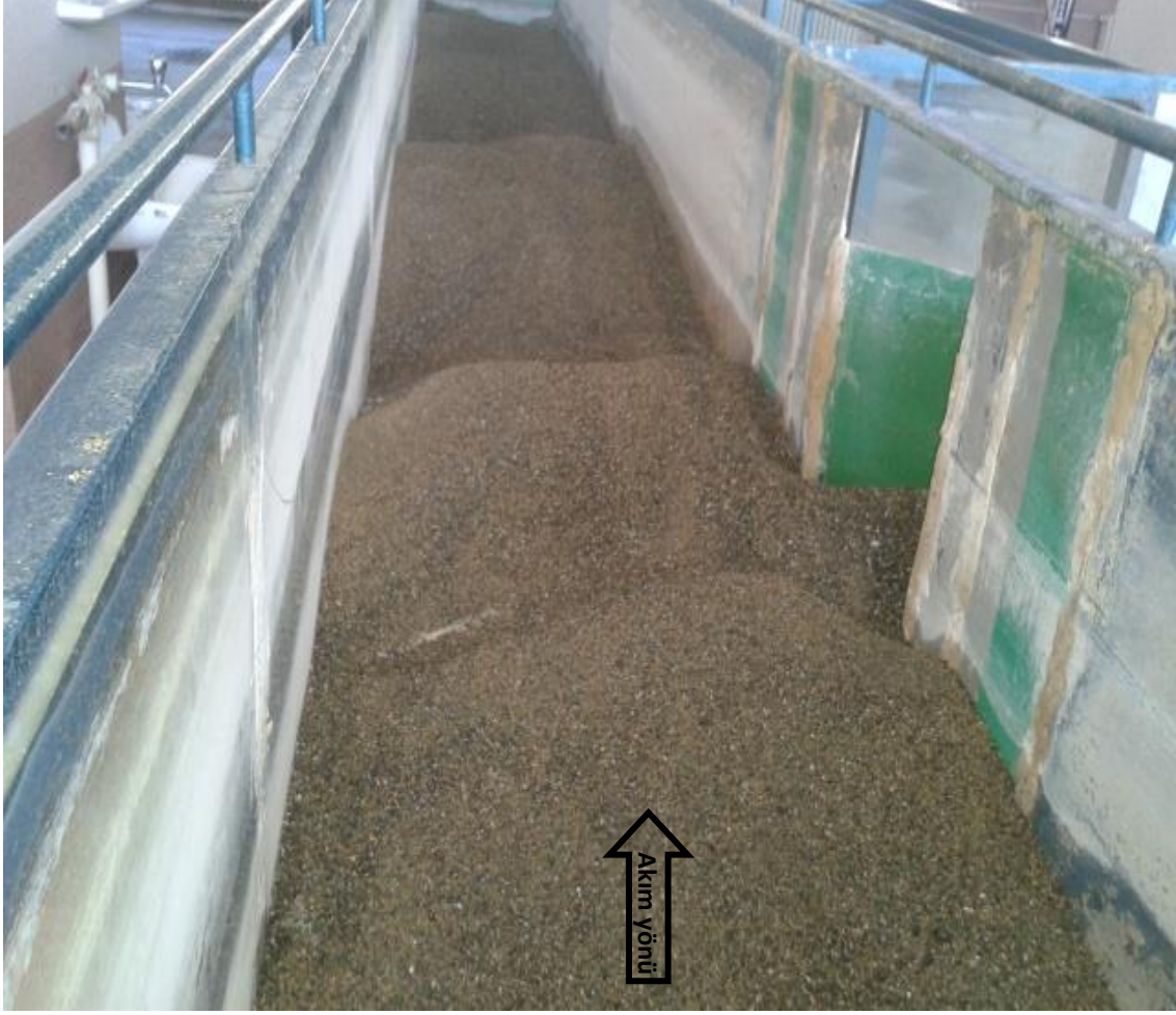
Şekil 4.9. Hareketli tabanlarda meydana gelen eşikler (dune)
