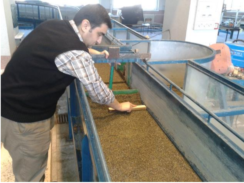
Şekil 5.9. Kanal tabanının düzleştirilmesi
