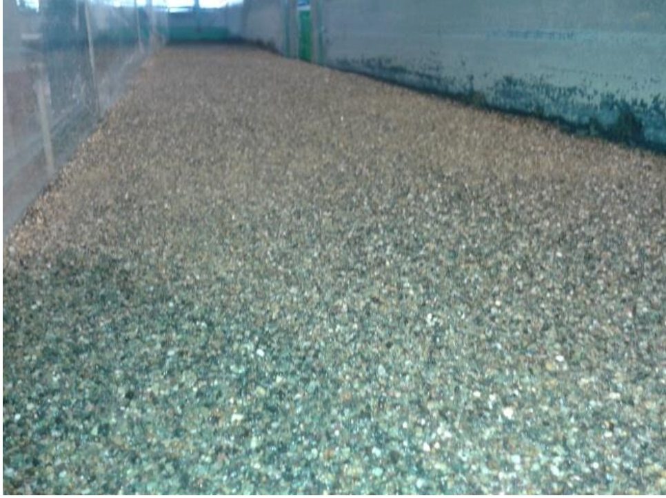
Şekil 5.10. Kanal tabanının deneye başlamadan önceki düzleştirilmiş hali
