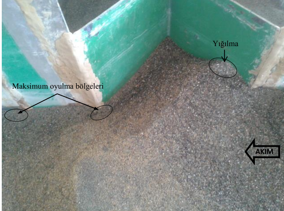
Şekil 6.2. p=16 L=40 V_1/V_{kr}=1.45 akım özelliklerine sahip deneyde maksimum oyulma derinliğinin yerini gösteren bir resim
