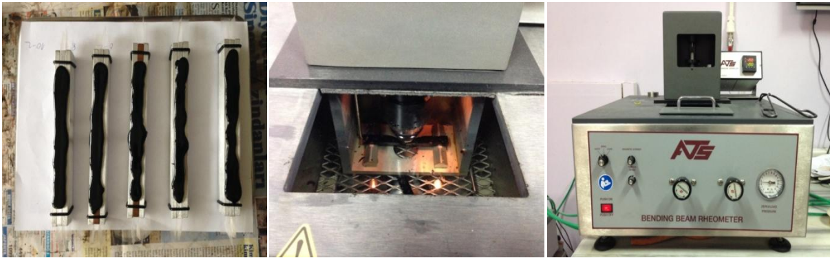
Şekil 3.5. BBR deneyi için numune hazırlanması ve deneyin yapılması
