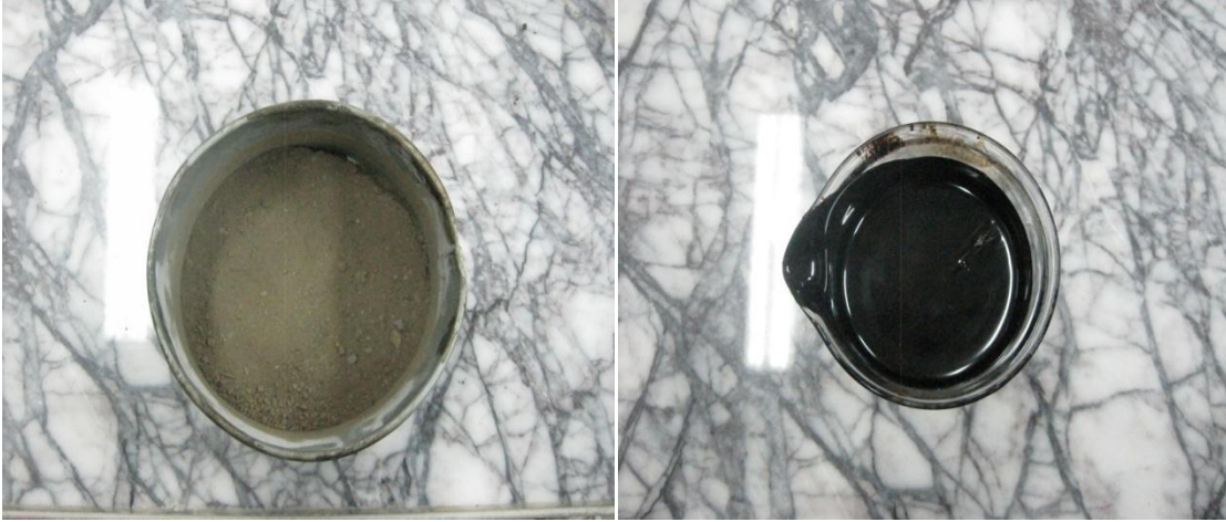
Şekil 4.3. Ekstraksiyon deneyi sonrasında Trinidad Göl Asfaltı'nın bitüm ve mineral kısmı
