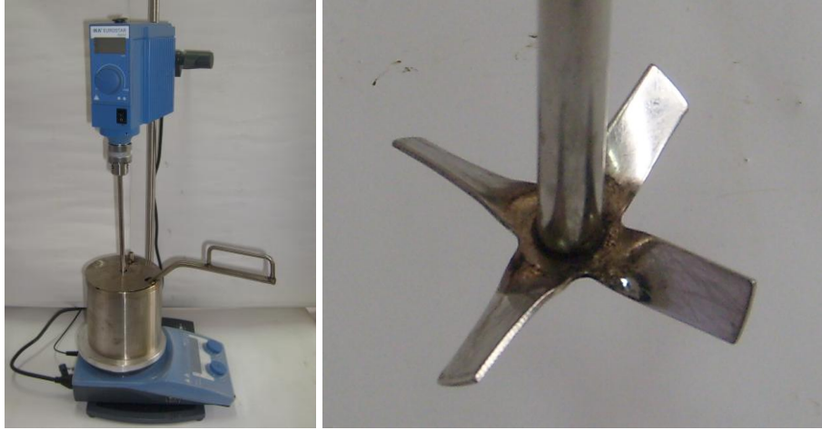
Şekil 4.4. Modifiye bitüm mikseri ve karıştırma başlığı
