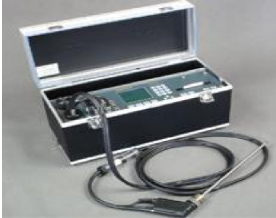
Şekil 3.6. Madur GA-21 Baca Gazı Ölçüm Cihazı
