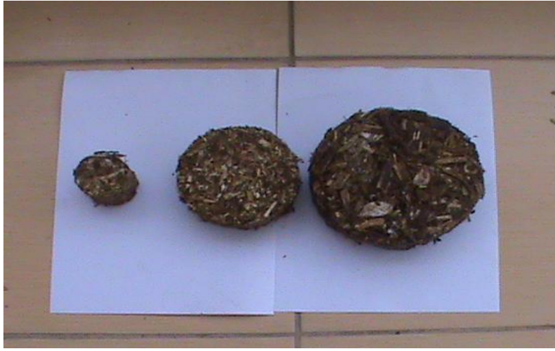
Şekil 2.13. Üç farklı Kalıpta Üretilen Briketler
