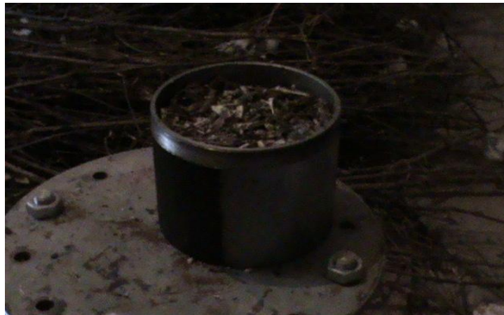
Şekil 2.11. Briket Malzemesinin Kalıplara Doldurulması
