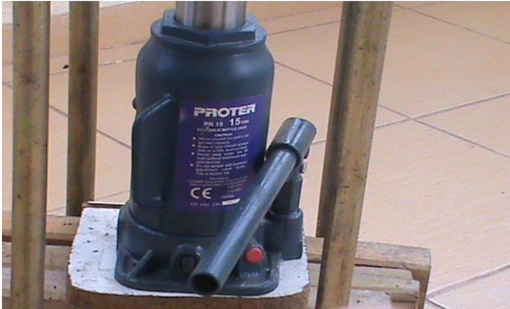
Şekil 2.10. 15 Tonluk Hidrolik Kriko
