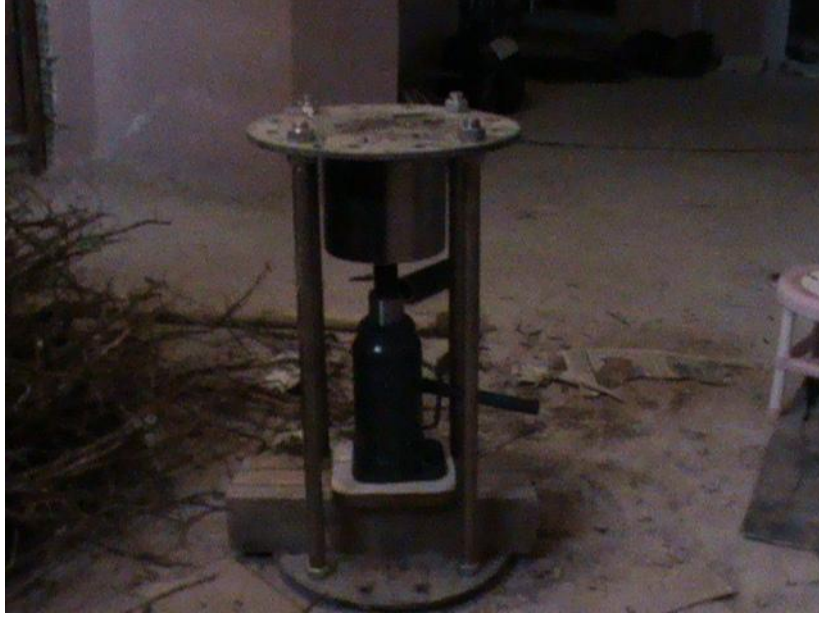
Şekil 2.12. Briket Malzemesinin Kalıpta Preslenmesi
