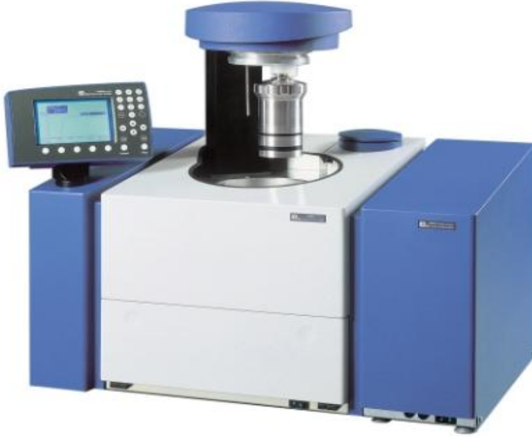
Şekil 3.1. IKA C5000-5003 Kalori Ölçüm Cihazı
