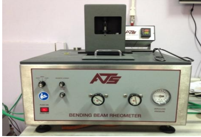
Şekil 5.8. Kiriş Eğme Reometresi deney aleti (BBR)
