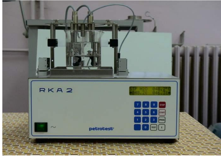
Şekil 5.2. Yumuşama noktası deney aleti
