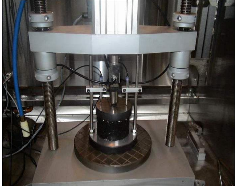
Şekil 5.16. Dinamik sünme deney düzeneği
