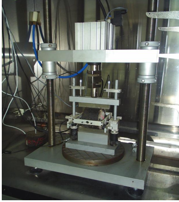
Şekil 5.13. İndirek çekme tekrarlı yorulma deney düzeneği
