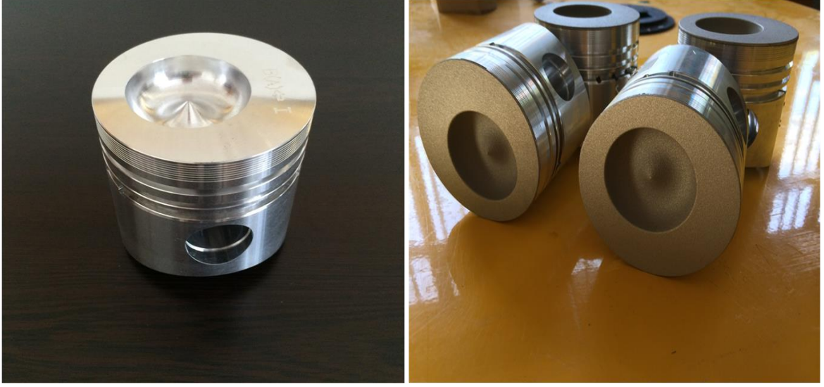
Şekil 2.23. Kaplama öncesi ve sonrası piston görüntüsü
