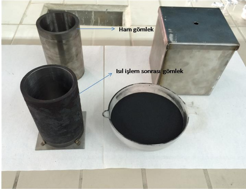
Şekil 2.17. Borlama öncesi ham gömlek ve ısı işlem görmüş gömlek
