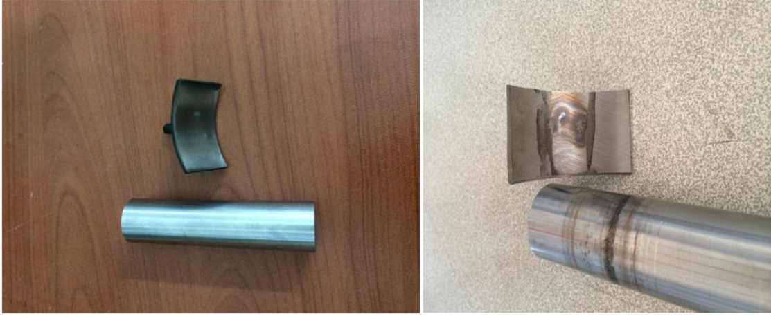
Şekil 4.41. a) Bor ile kaplanmış b) Kaplanmamış normal numunelere ait aşınma deneyi sonu resimleri.
