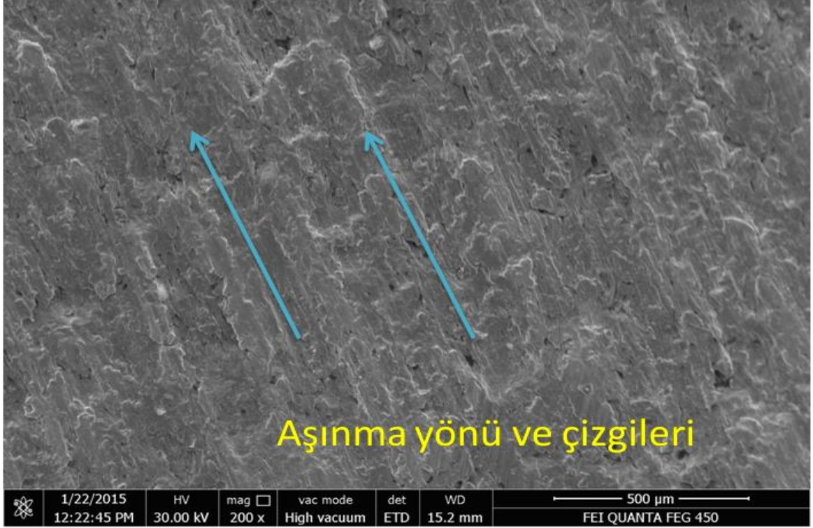
Şekil 4.44. Aşınmış dökme demirin SEM görüntüsü (200x)
