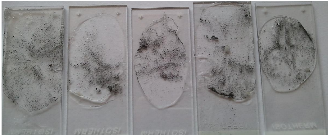
Şekil 7.4. Oluşan talaşların lamellere alınması
