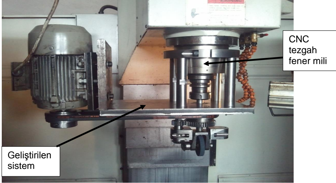
Şekil 5.1. Sistemin genel görünümü ve CNC fener miline montajlı hali
