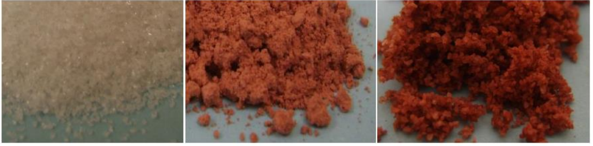
a) Aşındırıcı tanecikler b) Bağlayıcı elemanı c) Aşındırıcı ve bağlayıcı karışımı
