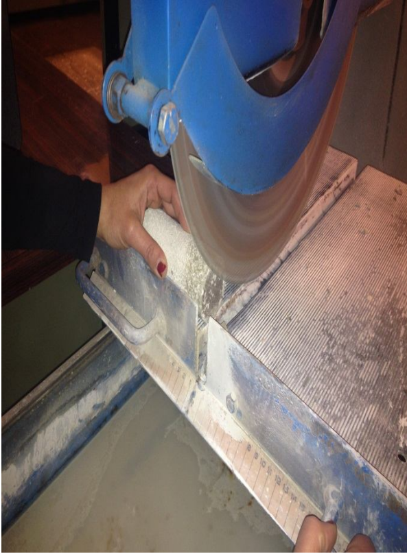
Şekil 4.10. Taş kesme makinası ile numunelerin kesilmesi Şekil 4.11. Serbest basınç deneyi
