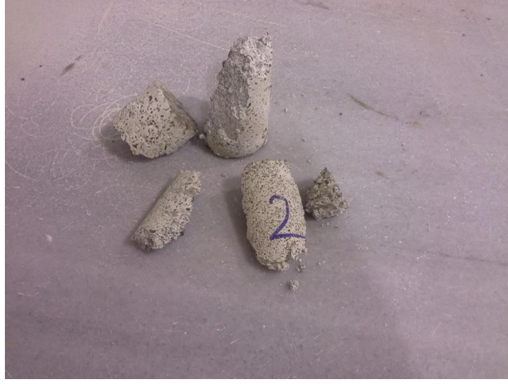
Şekil 4.12. Serbest basınç deneyi ile kırılmış numune
