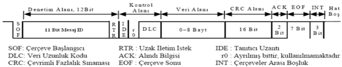
Şekil 4.5 11 Bit Kimlik Alanına Sahip CAN Mesajı.
