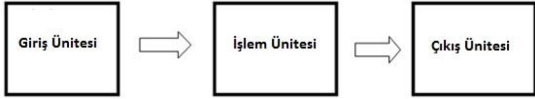
Şekil 2.1 Genel amaçlı bir mikro denetleyici temel bileşenleri
