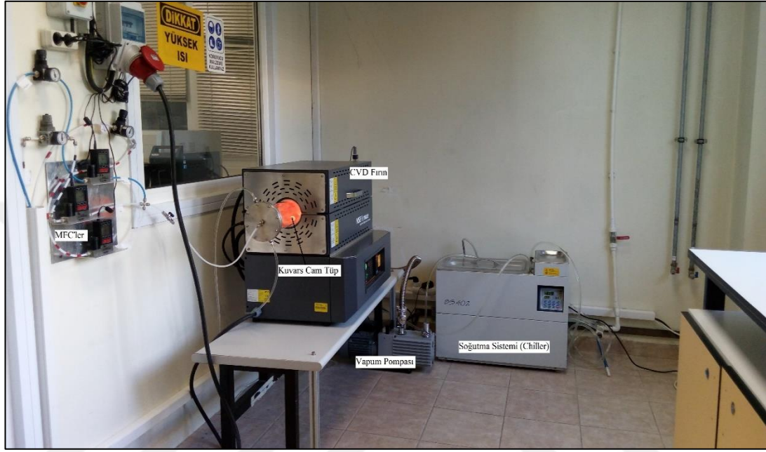
Şekil 3.1. TÜBİTAK MAM Enerji Enstitüsünde kurulan CVD sistemi
