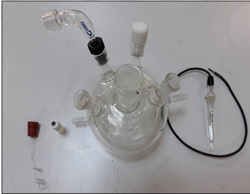
Şekil 3.11. Elektrokarakterizasyon çalışmalarında kullanılan elektrotlar ve hücre
