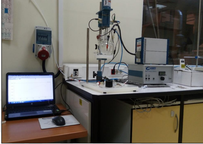
Şekil 3.10. GAMRY Reference 600 elektrokimyasal ölçüm sistemi
