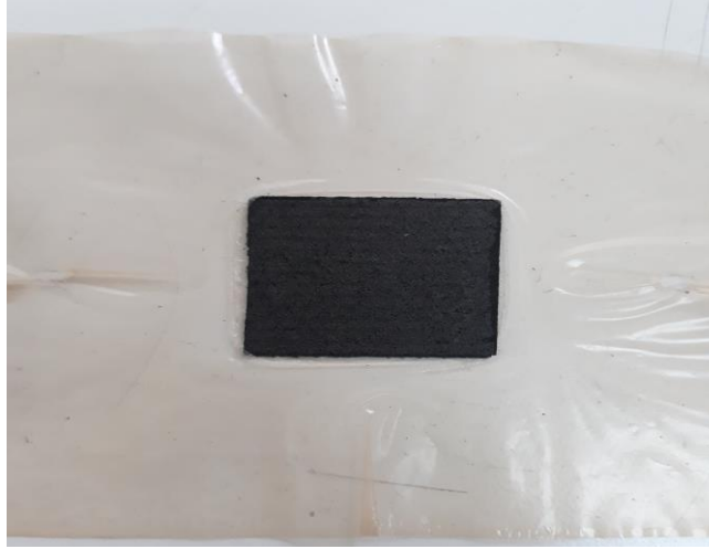
Şekil 3.16. Membran elektrot ünitesi
