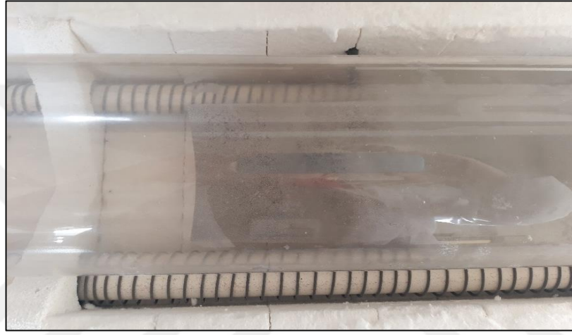
Şekil 3.2. Kuvars tüp içine yerleştirilmiş nikel köpük
