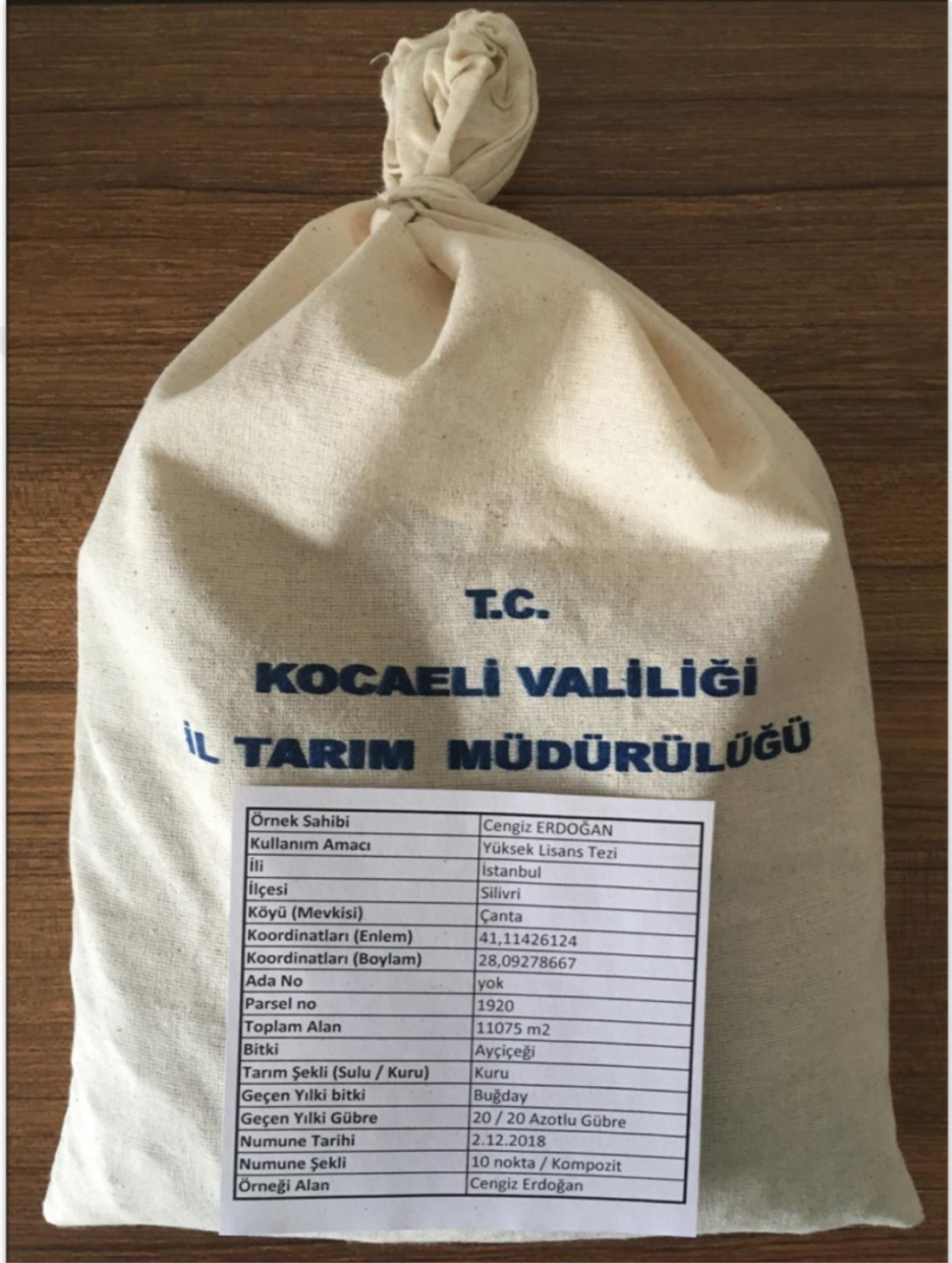
Şekil 5.4. Toprak numunesine ait numune etiketi bilgileri
