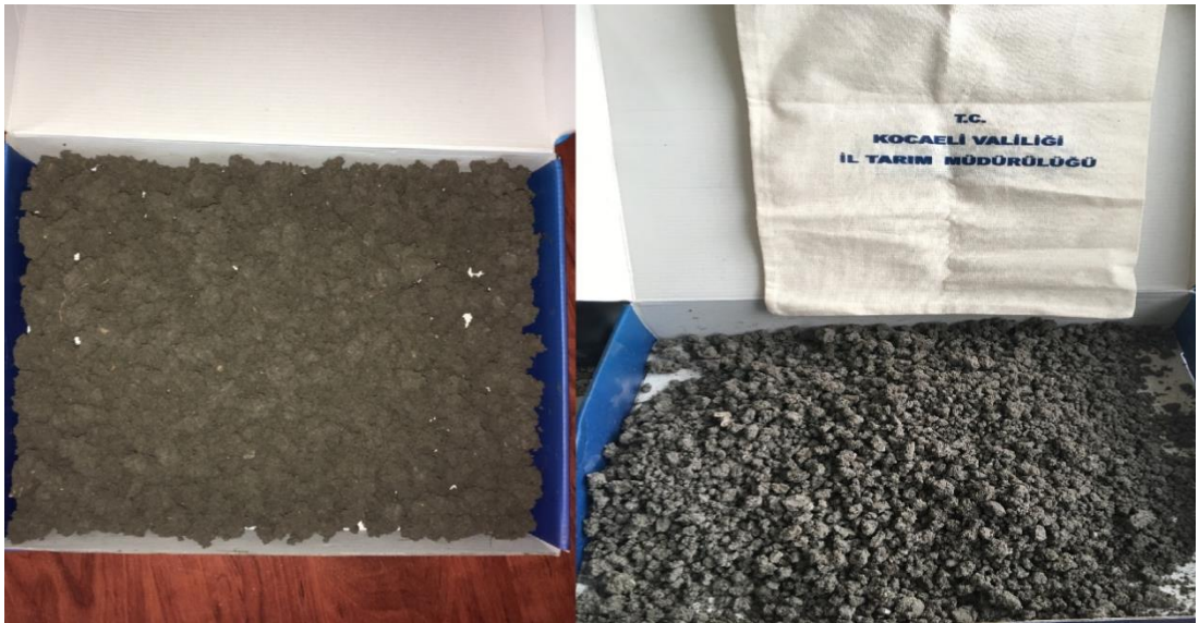
Şekil 5.3. Toprak numunesinin nemli ve kurutulduğu örnek
