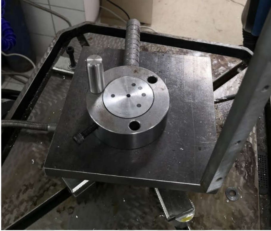
Şekil 7.12. Delme dinamometresinin üzerine işleme aparatının bağlanması
