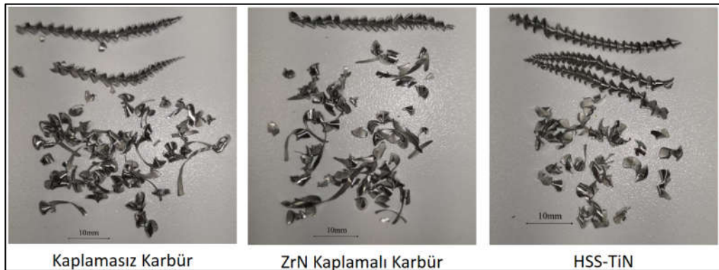
Şekil 7.57. AA7075-T4'ün soğutma sıvısı kullanılarak delinmesinde oluşan talaş yapıları
