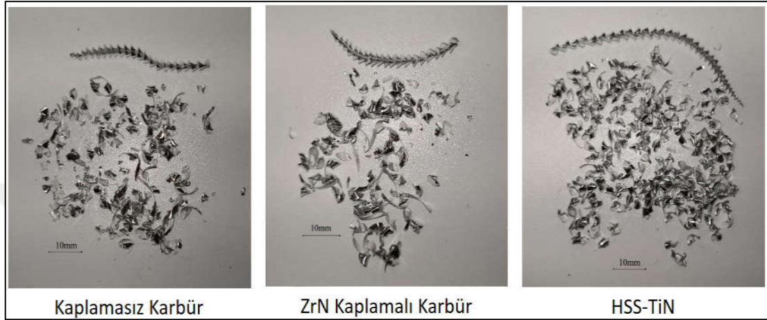
Şekil 7.58. AA7075-T6'nın soğutma sıvısı kullanılmadan delinmesinde oluşan talaş yapıları
