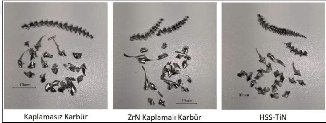
Şekil 7.61. AA7075-T73'ün soğutma sıvısı kullanılarak delinmesinde oluşan talaş yapıları
