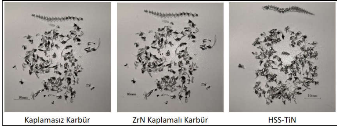
Şekil 7.60. AA7075-T73'ün soğutma sıvısı kullanılmadan delinmesinde oluşan talaş yapıları
