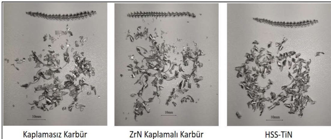
Şekil 7.54. AA7075-F'nin soğutma sıvısı kullanılmadan delinmesinde oluşan talaş yapıları
