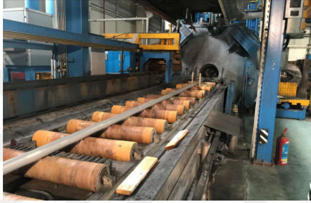
Şekil 7.1. \varnothing 60 mm çubuk profilin ekstrüzyon yöntemi ile üretilmesi
