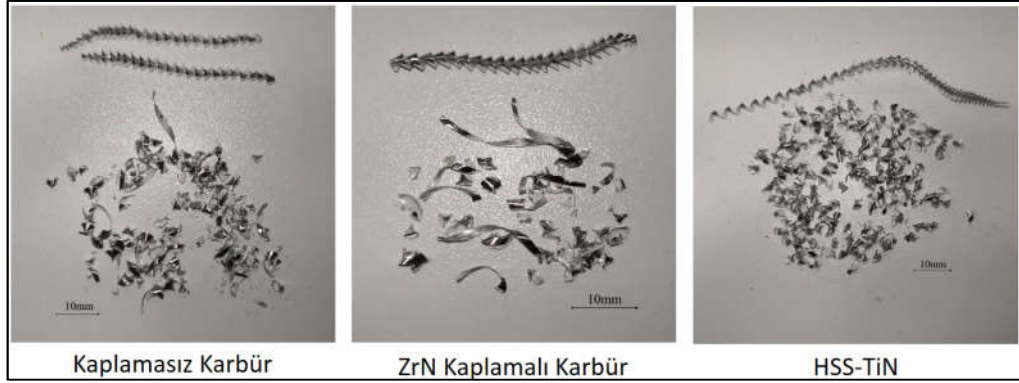
Şekil 7.56. AA7075-T4'ün soğutma sıvısı kullanılmadan delinmesinde oluşan talaş yapıları
