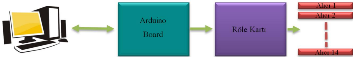
Şekil 2.33. Elektrik panosu akış diyagramı
