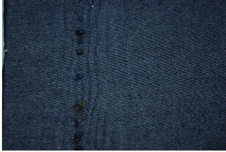
Şekil 3.1. Pamuklama hatası içeren denim kumaş görüntüsü
