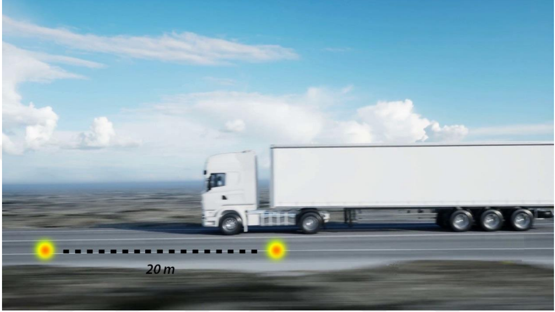
Şekil 3.17. Reflektörlerin yerleşim şeması
