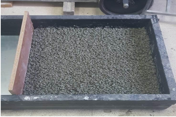
Şekil 4.7. 9.5 mm-12.5 mm dane çapı aralığında agrega ile hazırlanan poroz betonunun kalıptaki görünümü
