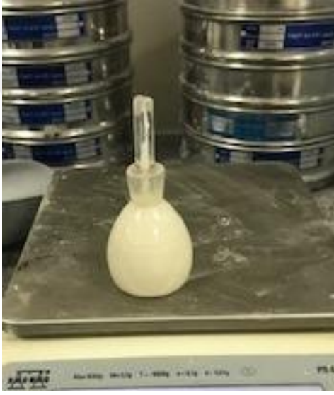
Şekil 3. 3. Hazırlanan piknometre + su + numune
