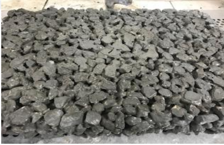
Şekil 4.5. 3. Denemede elde edilen poroz beton numunesi
