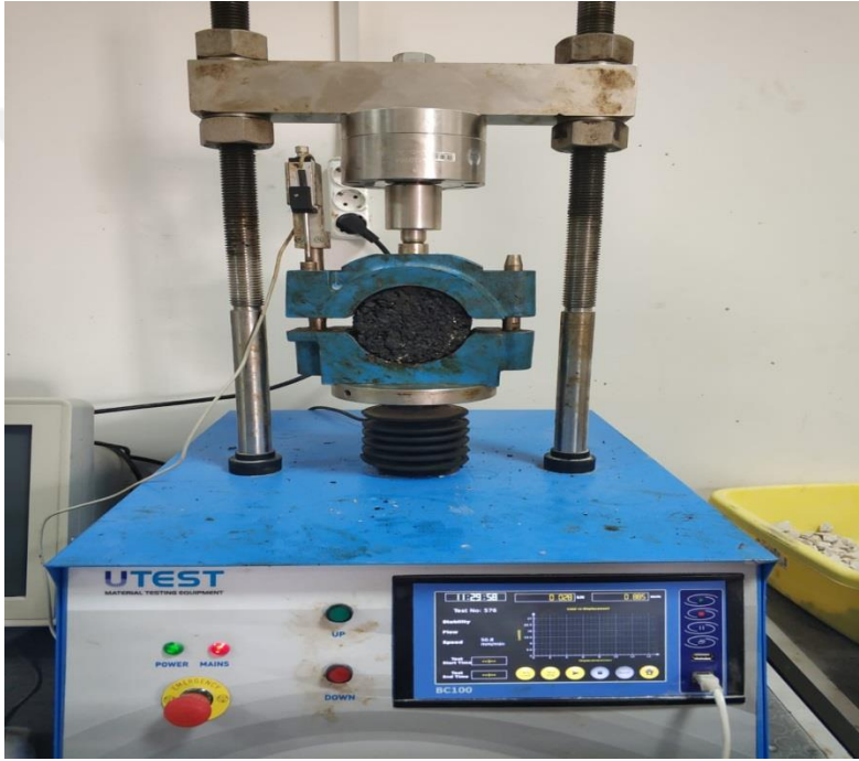
Şekil 3. 18. Marshall stabilite deney cihazına numunenin yerleştirilmesi
