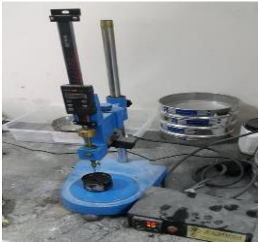
Şekil 3. 14. Penetrasyon deney cihazı
