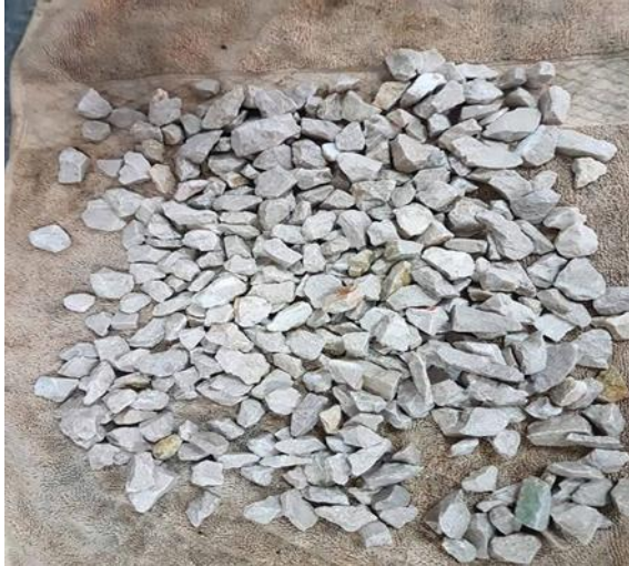
Şekil 3. 1. Sudan çıkarılan agreganın havlu ile kurutulması
