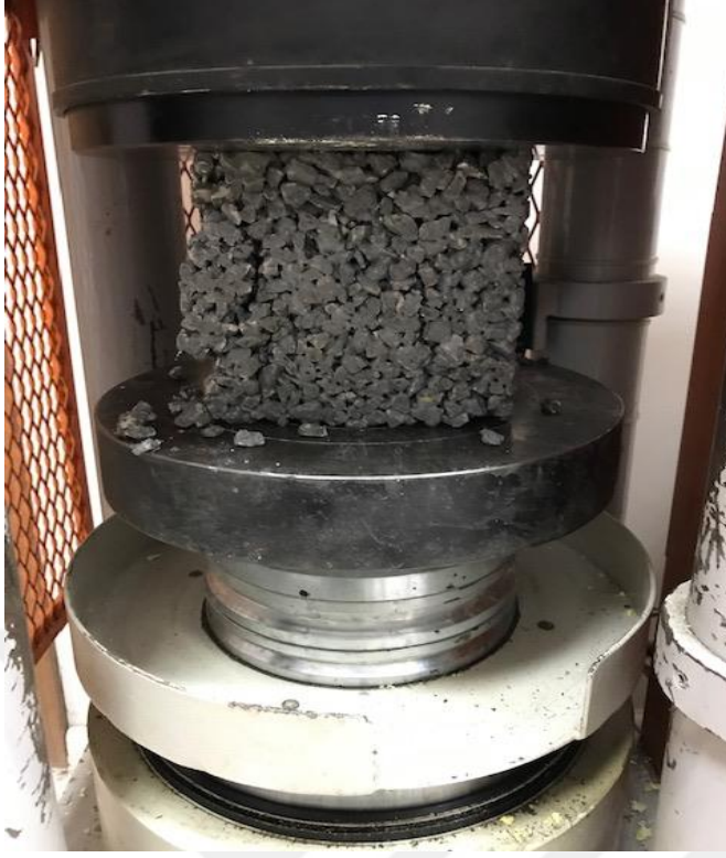
Şekil 3. 13. Poroz betonun basınç dayanımı deney cihazında maksimum taşıma basıncının bulunması
