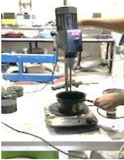
Şekil 3. 16. Modifiye bitümün hazırlanması
