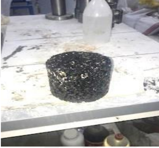
Şekil 3. 17. Poroz Asphalt Marshall Numunesi
