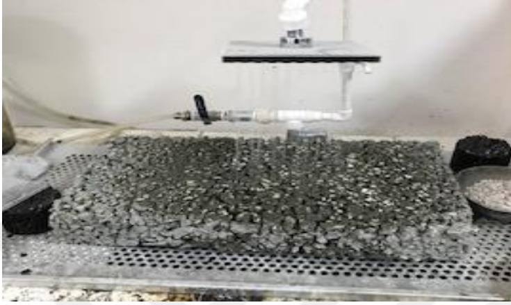
Şekil 4.8. Su altında agrega- çimento ayrışmasının incelenmesi
