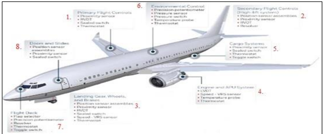
Şekil 2.12. Uçaklarda kullanılan sensörler ve kullanım bölgeleri
