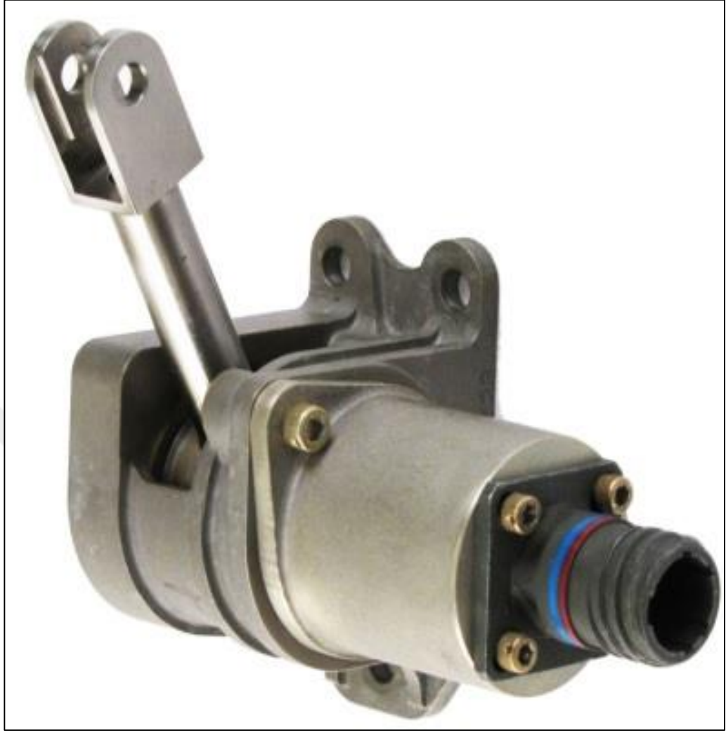
Şekil 2.4. Uçaklarda kullanılan RVDT sensör
