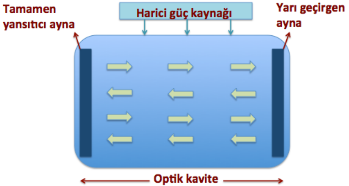
Şekil 2. 2. Lazer sisteminin bileşenleri
