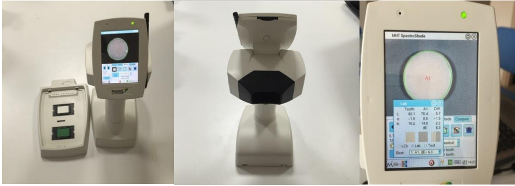
Şekil 3.9. Spektrofotometre cihazı ile translusensi ve renk ölçümü
