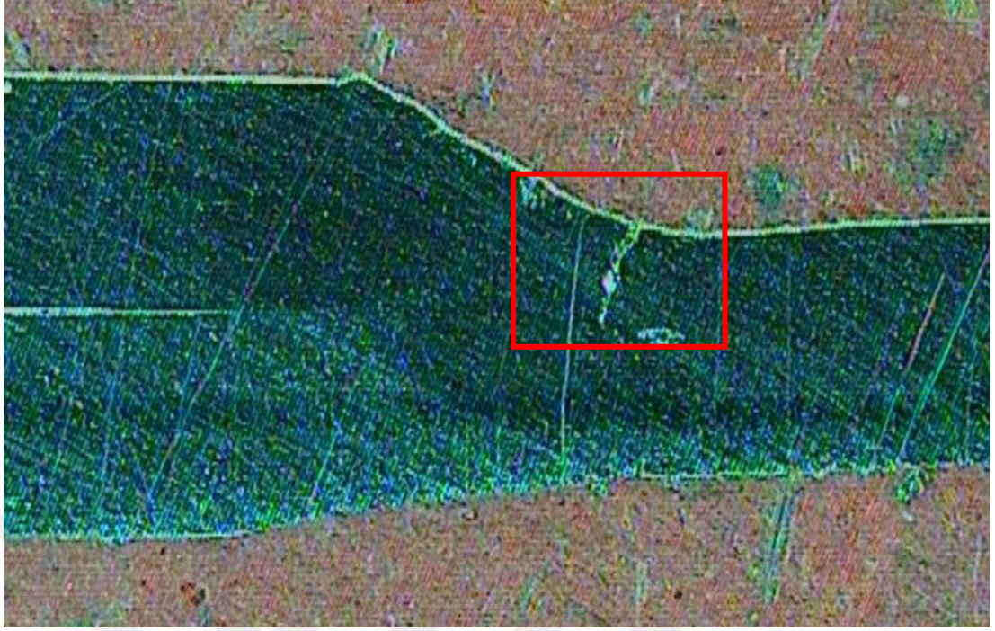
Şekil 4.19. Kaynağında çatlak görülen 10 kA 12 cyc 300 kgf parametrelerinde kaynatılmış farklı kalınlıktaki farklı malzemeler
