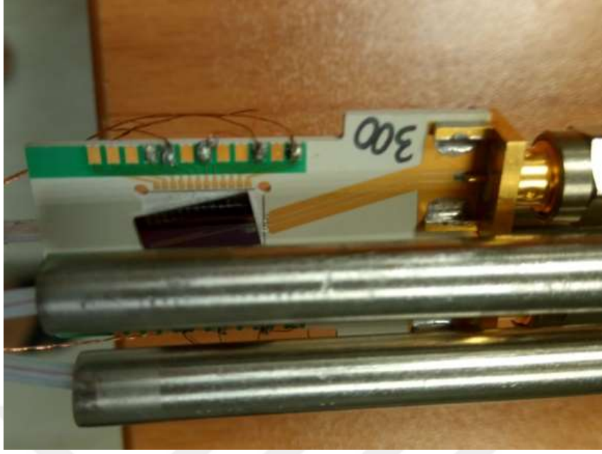
Şekil 4. 1. Yapıştırıldığı PCB'den Kopan Tümdevre
