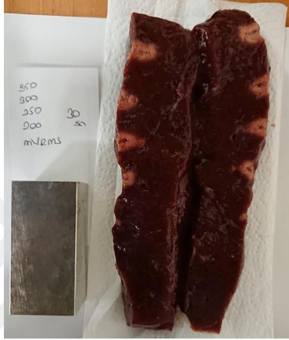
Şekil 2.16. 350-300-250-200 mV RMS Genlik değerlerinde 30 sn HIFU uygulaması karaciğer doku parçası ve referans parça
