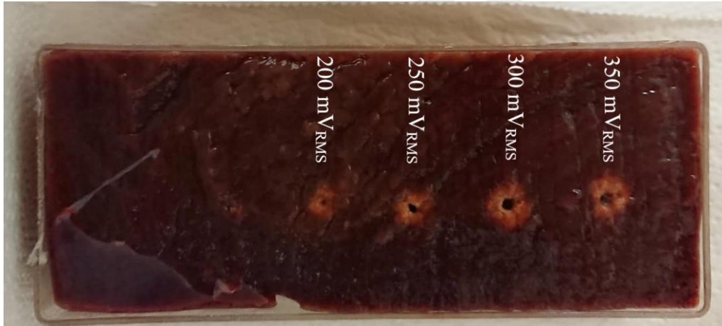
Şekil 2.13. Farklı genlik değerlerinde 30 saniye HIFU uygulanan ex-vivo doku yüzey görünümü
