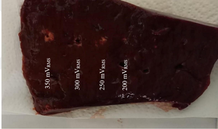
Şekil 2.15. Farklı genlik değerlerinde 10 sn HIFU uygulanan ex-vivo doku yüzey görünümü
