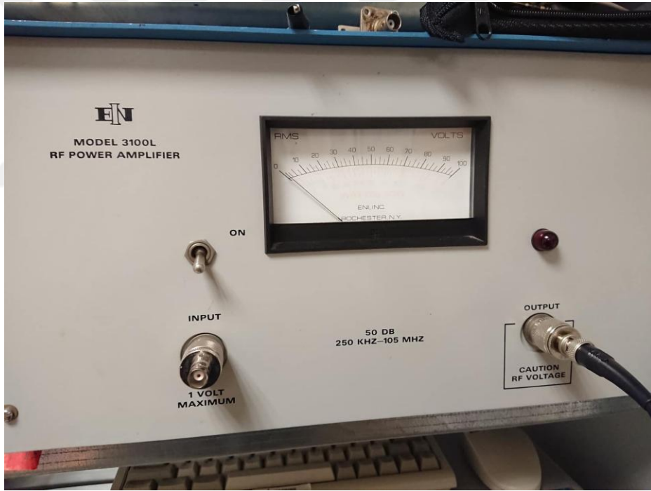
Şekil 2.2. Deney düzeneğinde kullanılan güç yükselteci
