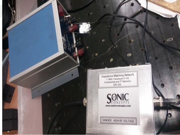
Şekil 2.5. RF Empedans eşleştirme ağı (sağ alt), güç kaynağı (sol üst)
