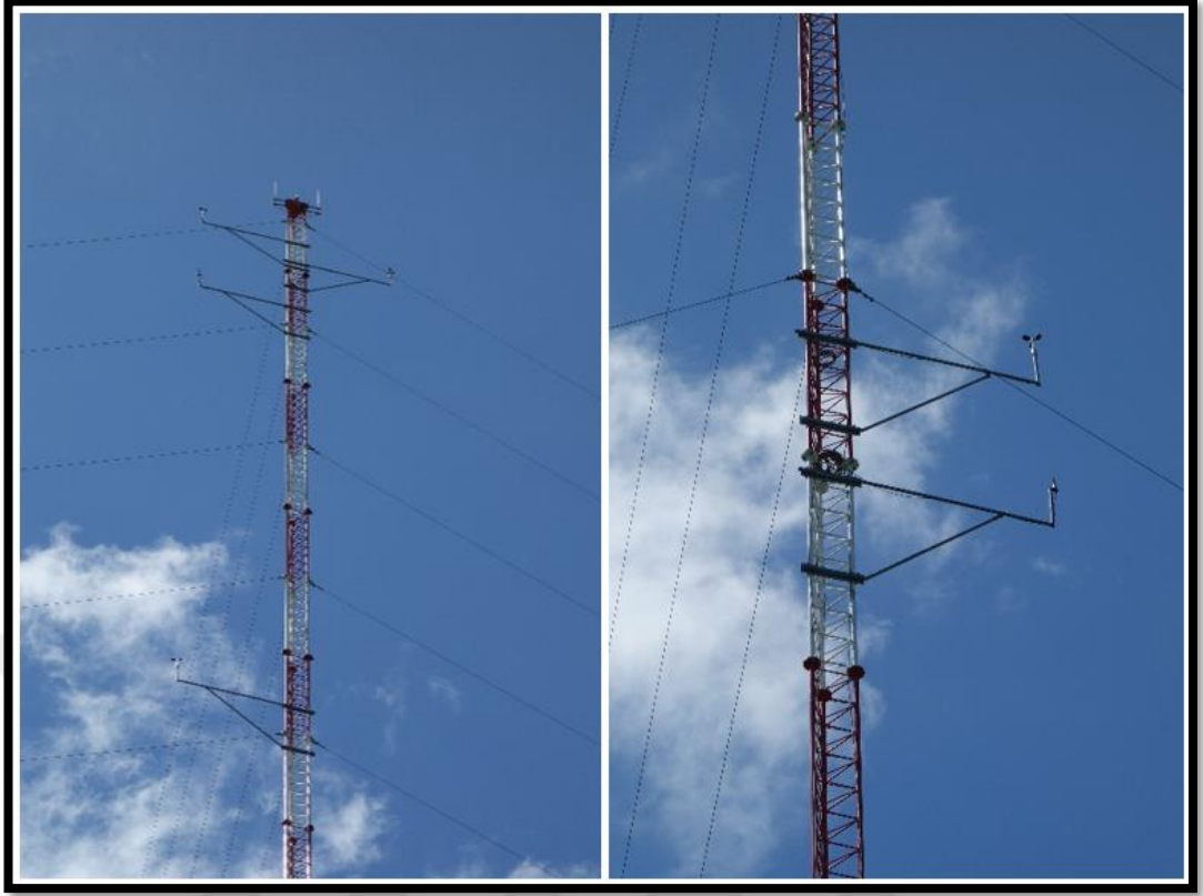
Şekil 3.4. Sensörlerin direk üzerindeki konumları
