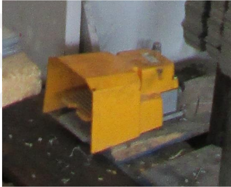
Şekil 3.31. Preslerde kullanılan kilitlemeli ve pedal koruyuculu ayak pedalı kumandası
