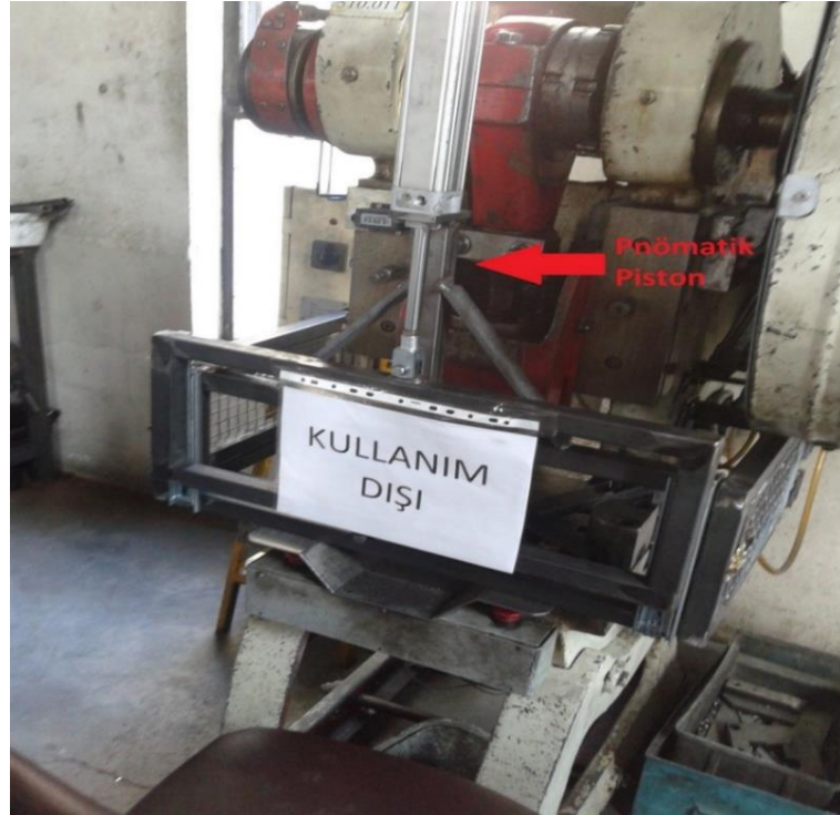
Şekil 4.6. Presin ön kapak ve pnömatik piston tasarımının deneme aşaması
