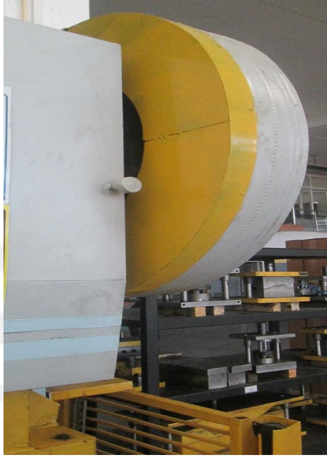
Şekil 3.16. Volan dişlisi mekanik koruyucu örneği
