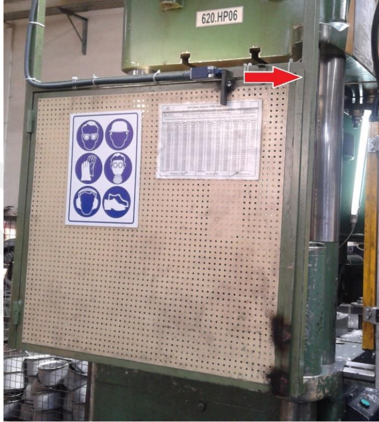
Şekil 3.19. Pres makinesi yan bölüm switch tertibatlı mekanik koruyucu örneği
