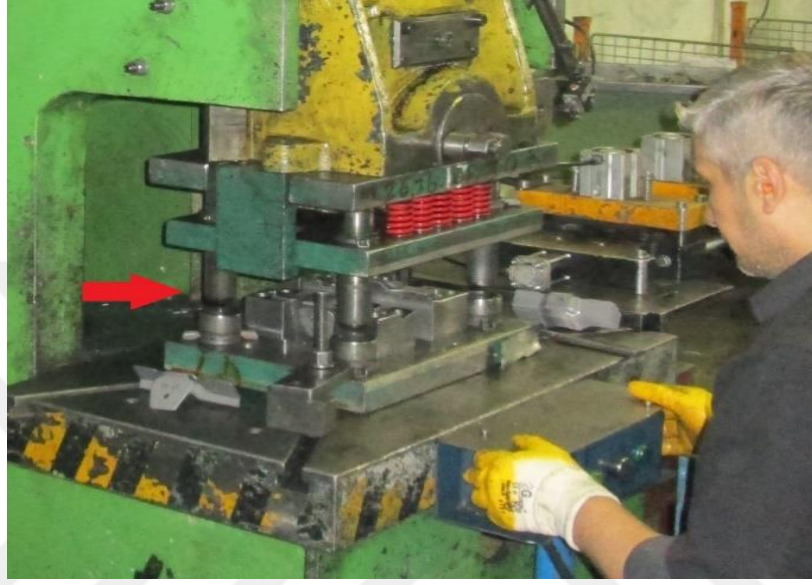
Şekil 3.29. Preslerde kullanılan açık kalıp şekli
