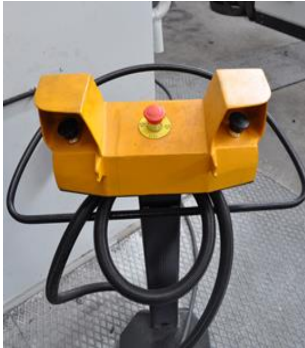
Şekil 3.20. Acil durdurma butonu bulunan çift el kumanda tertibatı örneği [21]
