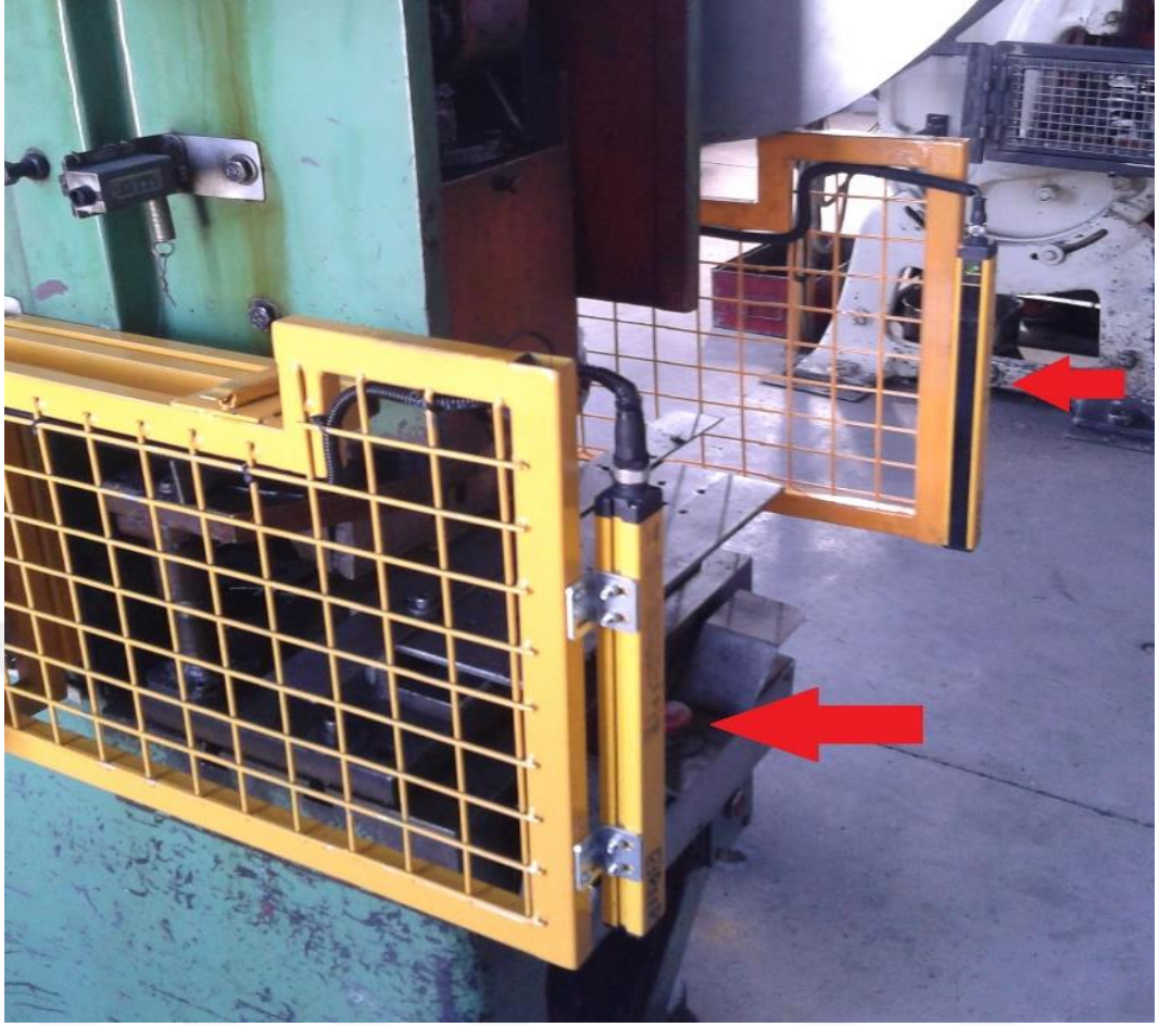
Şekil 3.22. Preste yan kafes koruyucusuna bağlı ışık perdesi uygulama örneği
