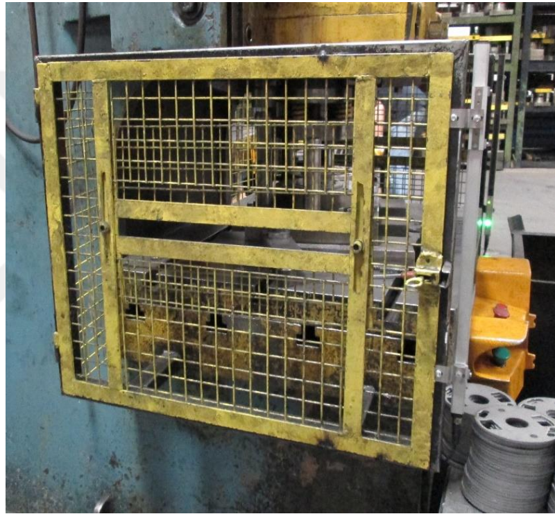
Şekil 3.18. Pres makinesi yan bölüm malzeme besleme açıklığı olan mekanik koruyucu örneği
