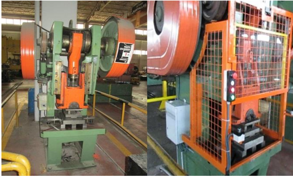
Şekil 4.7. Mandal kavramalı preste pnömatik pistonlu ön kapak revizyonu öncesi (sol) ve sonrası (sağ)
