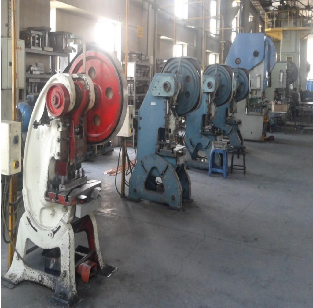
Şekil 4.1. Uygulama yapılan “A” unvanlı işyerindeki mandal kavramalı eksantrik preslerin ilk hali
