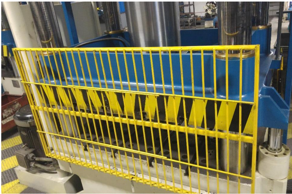
Şekil 3.17. Pres makinesi arka bölüm sabit mekanik koruyucu örneği
