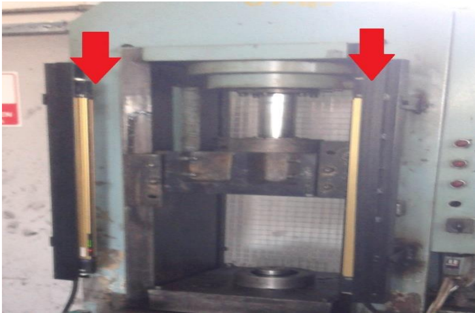
Şekil 3.21. Hidrolik bir preste ışık perdesi uygulama örneği
