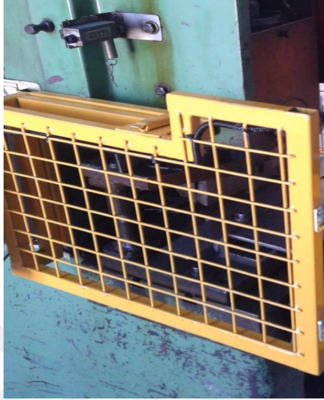
Şekil 4.3. Preslerin yan kısımlarına yapılan switch tertibatlı kapak koruyucusu
