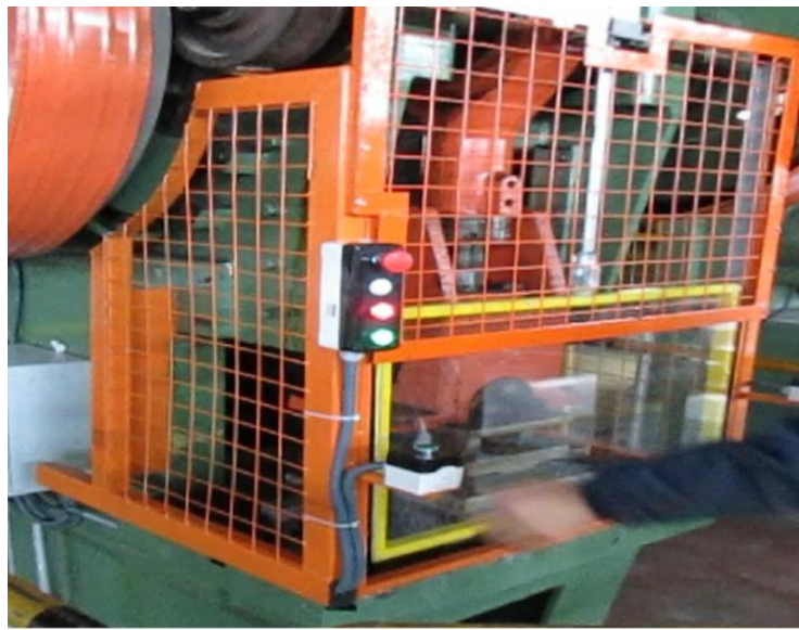
Şekil 4.8. Mandal kavramalı preste pnömatik pistonlu ön kapak aşağı inme hareketi
