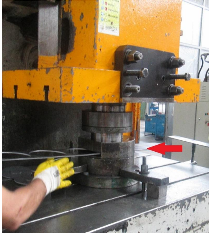
Şekil 3.30. Preslerde kullanılan kapalı kalıp şekli
