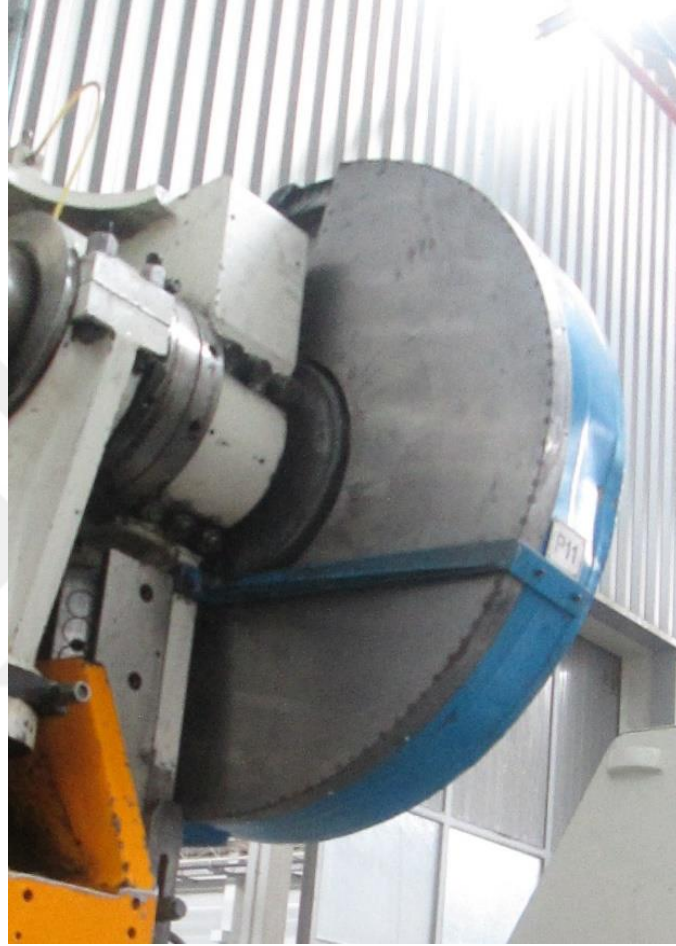
Şekil 4.2. Volan dişlisi mekanik koruyucu uygulaması
