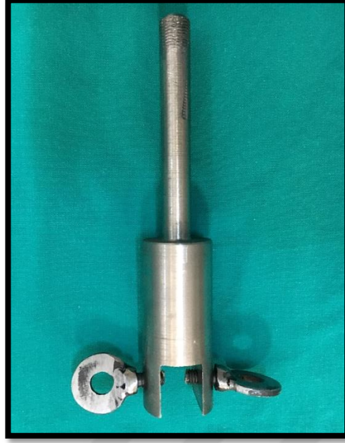
Şekil 3.15. Deneyde kullanılan kuvvet kolu aparatı
