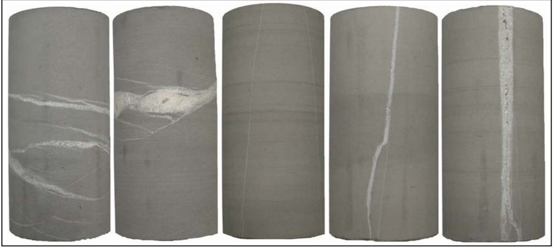
Şekil 5.18. Üç eksenli basınç deneyinde kullanılan kalsit dolgulu süreksizlik içeren E.L.İ. marn kaya malzemesi örnekleri.
