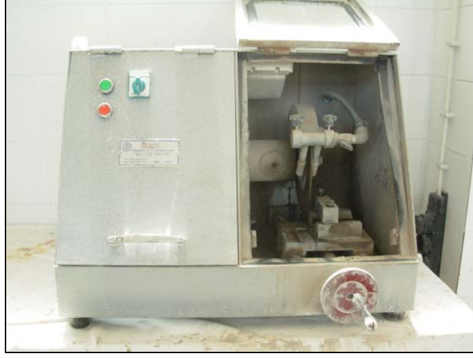
Şekil 5.3. Karot başlarının düzeltilmesinde kullanılan karot kesim makinesi.
