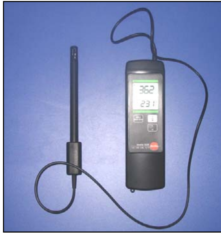
Şekil 4.4. Yeraltı iklim koşullarının belirlenmesinde kullanılan termo-higrometre.
