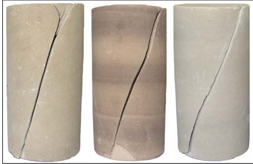
Şekil 5.16. G.L.İ. marn kaya malzemesi örneklerinin üç eksenli basınç deneyi sonrası yenilme şekilleri.
