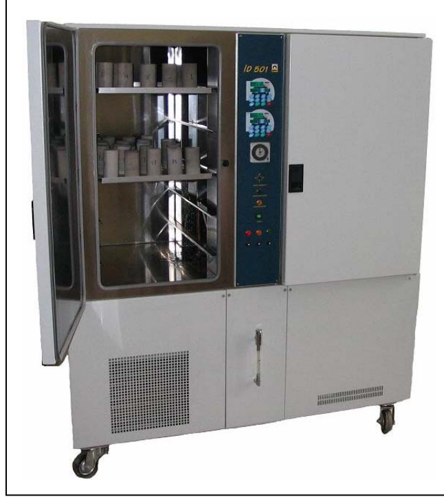
Şekil 5.8. İklimlendirme dolabında marn örneklerinin koşullandırılması.
