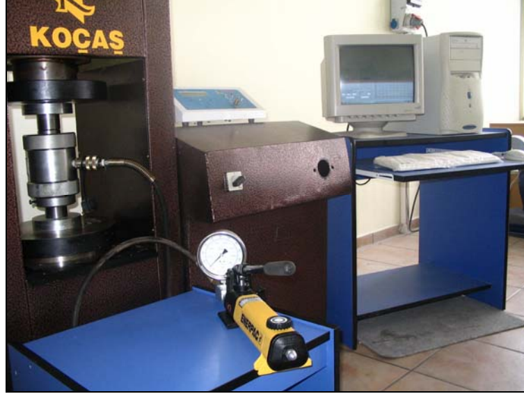
Şekil 5.14. Üç eksenli basınç dayanımı deneylerinde kullanılan deney düzeneği.
