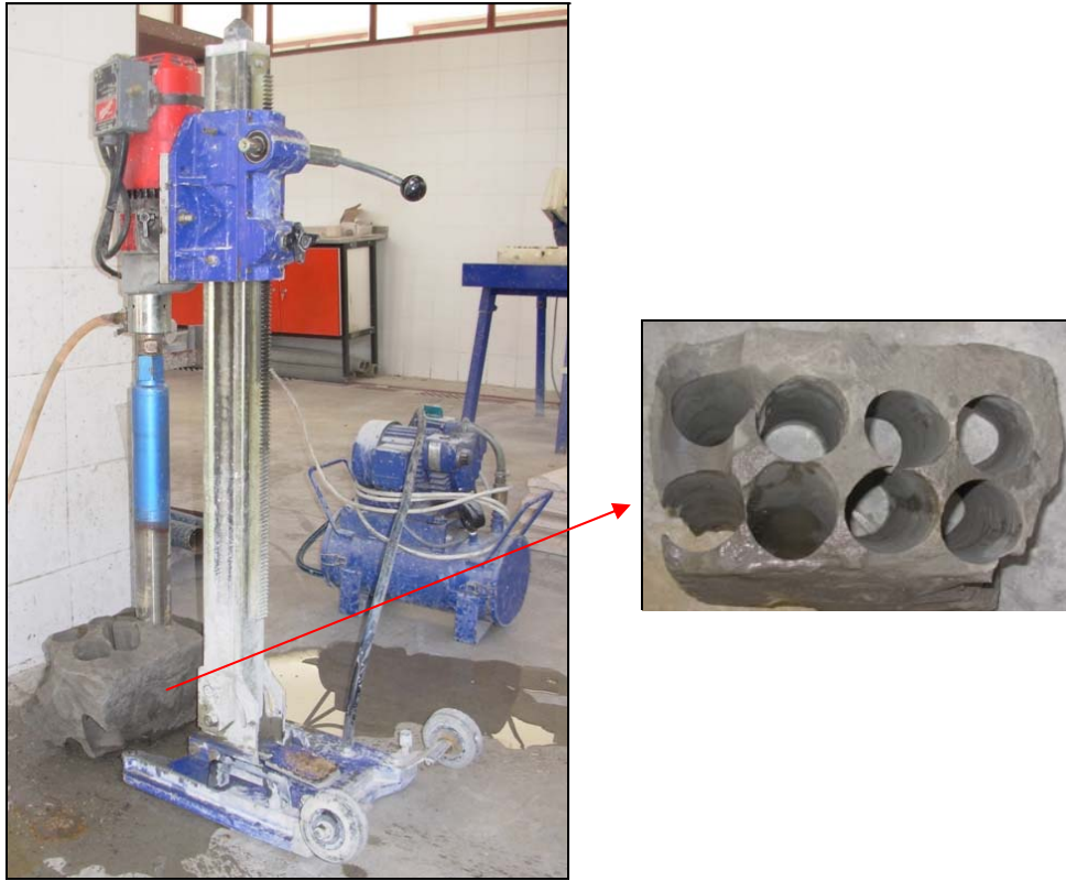
Şekil 5.2. NX boyutunda örnek almak için kullanılan karot alma makinesi.
