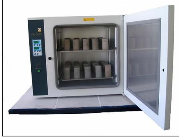
Şekil 5.7. Marn numunelerinin etüv içerisinde kurutulması.
