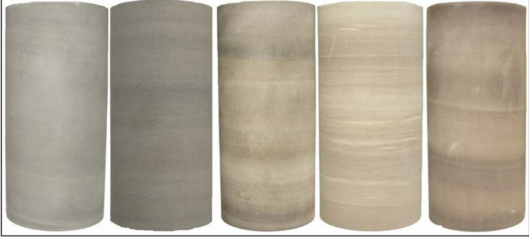
Şekil 5.15. Üç eksenli basınç deneyinde kullanılan G.L.İ. marn kaya malzemesi örnekleri.
