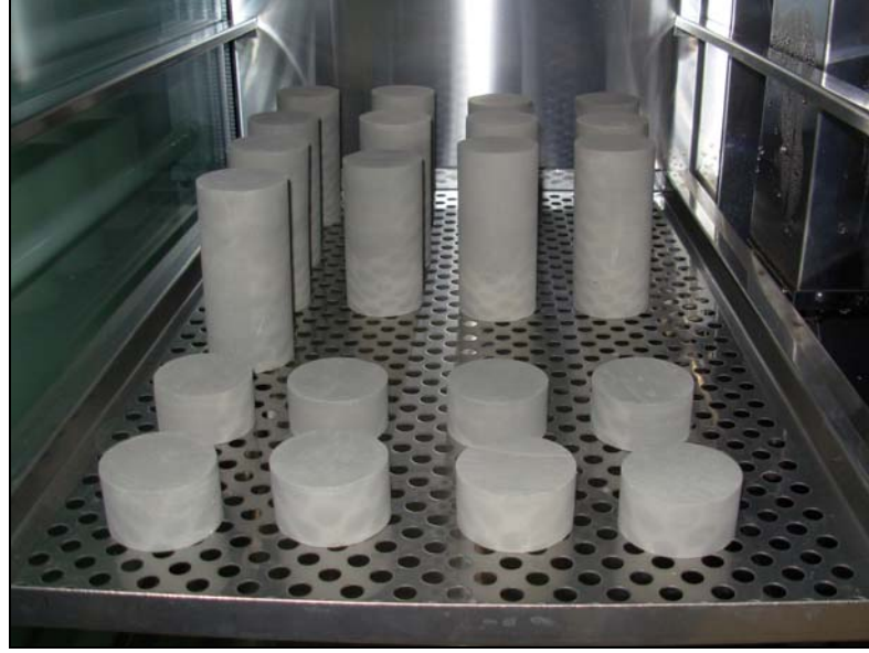
Şekil 5.22. Brazilian çekme deneyi için G.L.İ. marn örneklerinin koşullandırma işlemi.
