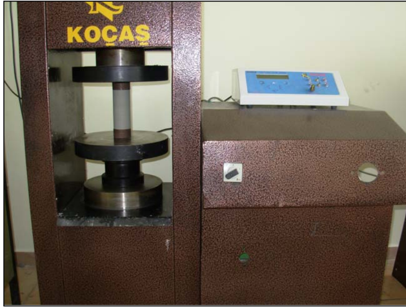
Şekil 5.20. Tek eksenli basınç dayanımı deneyinde kullanılan deney düzeneği.
