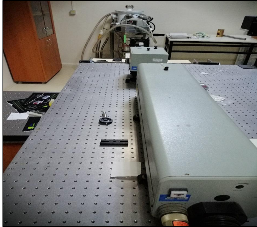
Şekil 4.4. Nanosaniye lazer ve lazer ablasyon deney düzeneği
