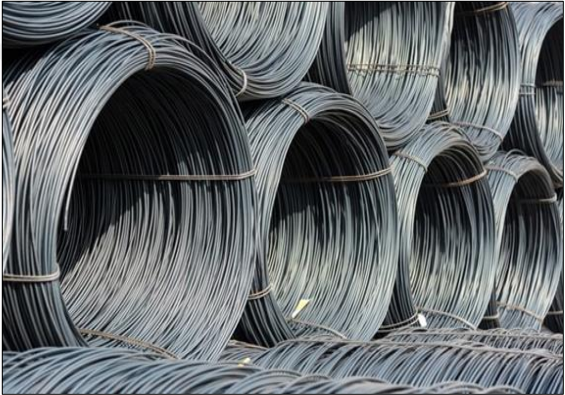
Şekil 2.3. Tel çekme işleminde kullanılan hammaddeleri gösteren bir makro görsel [8]
