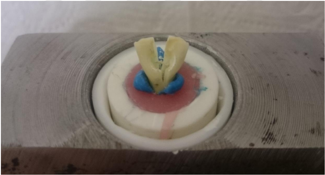
Şekil 4.6. Mine-sement sınırını geçen restore edilemeyen kırık
