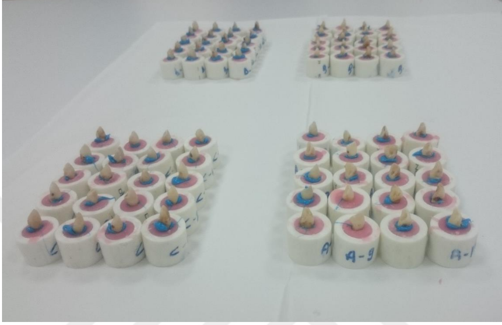
Şekil 3.8. Plastik silindir kalıplara gömülü örnekler
