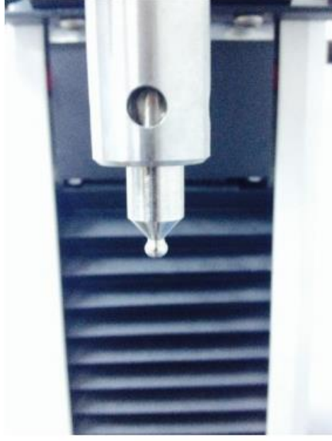
Şekil 3.11. Çalışmamızda kullanılan paslanmaz çelik uç
