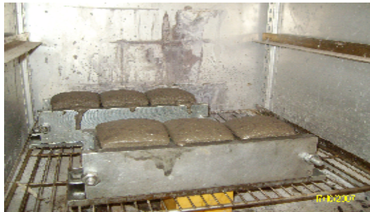
Şekil 5.5.3. Etüvde, kireç-alüminyumun reaksiyonu sonucu numunelerin kabarması
