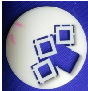
Şekil 3.5. Örneklerin hazırlanması için kullanılan kalıp
