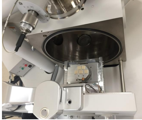
Şekil 3.25. Örneklerin SEM cihazına yerleştirilmesi
