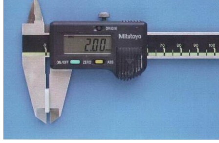
Şekil 3.10. Örnek kalınlıklarının dijital kumpasla ölçülmesi
