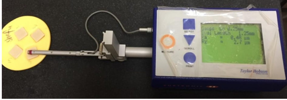
Şekil 3.19. Örneklerin yüzey pürüzlülüğünün ölçümü
