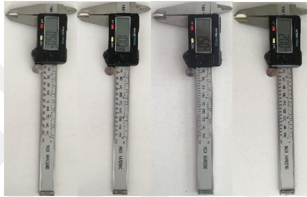
Şekil 3.6. Örneklerin kalınlıklarının dijital kumpas yardımıyla ölçülmesi
