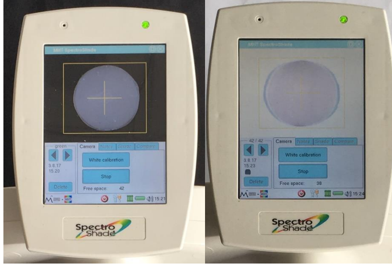
Şekil 3.9. Monolitik zirkonyum örneklerin ilk translüsensi ölçümlerinin yapılması
