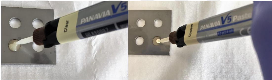
Şekil 3.13. Örneklerin üzerine şeffaf ve opak renkteki adeziv rezin simanın yerleştirilmesi
