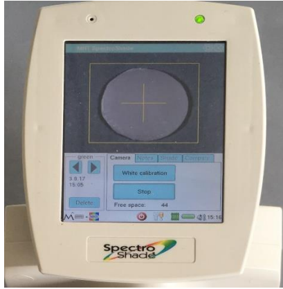
Şekil 3.8. Gri arka plan üzerinde örneklerin renk ölçümünün yapılması
