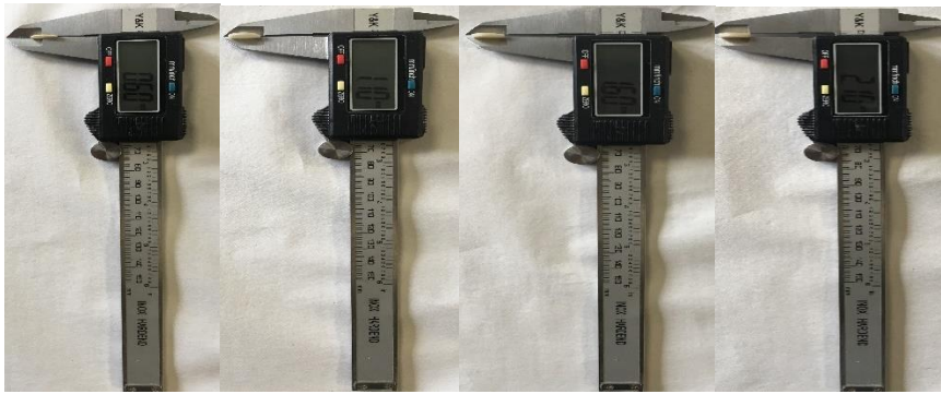
Şekil 3.16. Örnek kalınlıklarının simantasyondan sonra ölçülmesi
