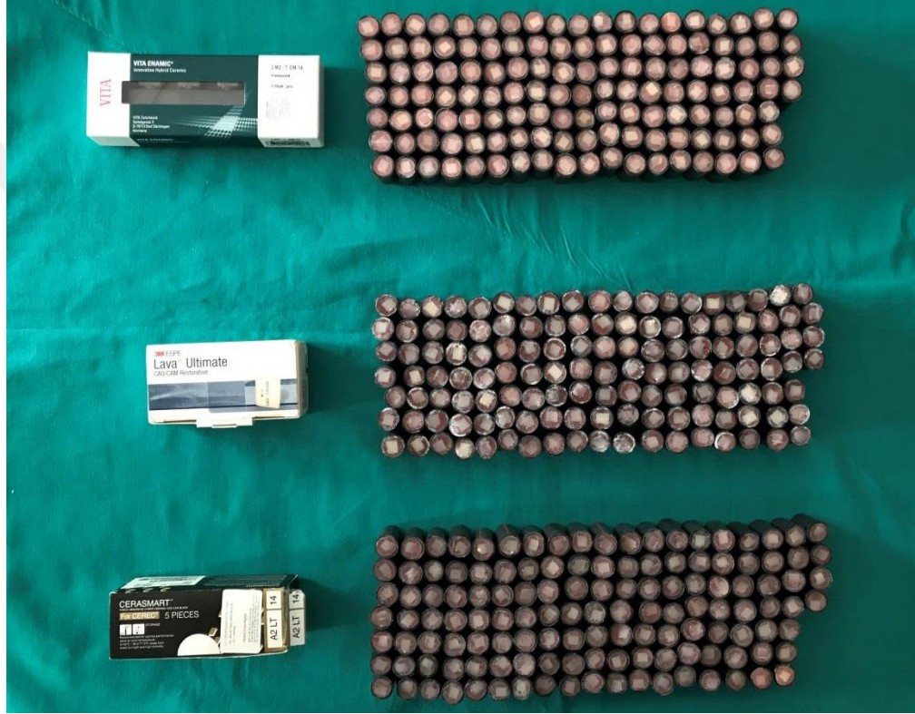
Şekil 3.4. Seramik örneklerin akrilik bloklar içerisine gömülmüş hali
