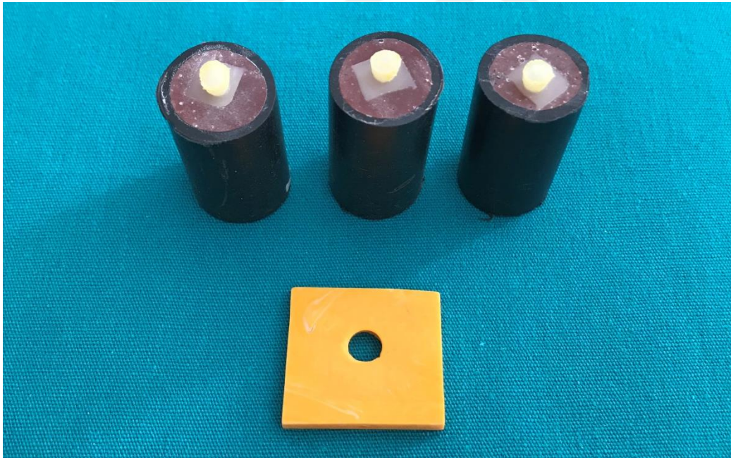
Şekil 3.7. Seramik örneklerin üzerine rezin siman uygulanması
