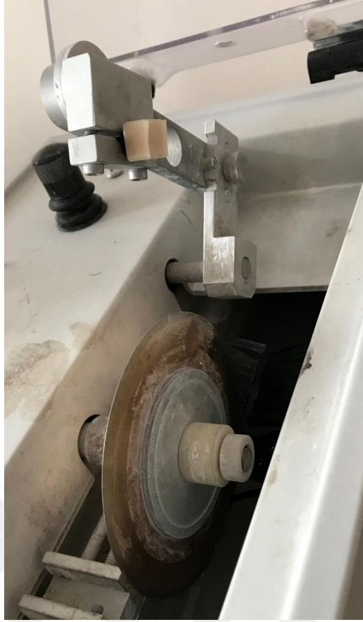
Şekil 3.2. Seramiklerin ISOMET cihazıyla kesilmesi
