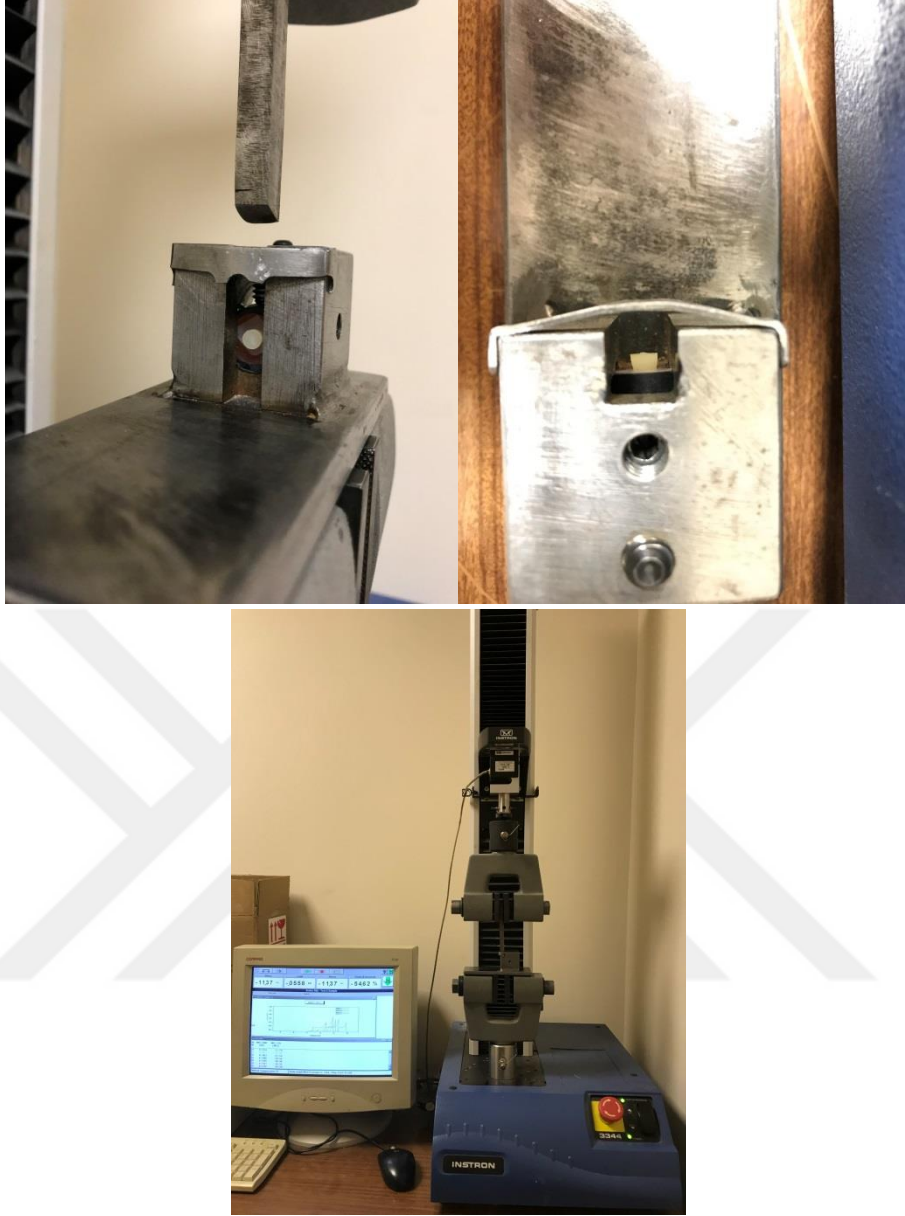
Şekil 3.8. Rezin simanların INSTRON cihazında kırılması
