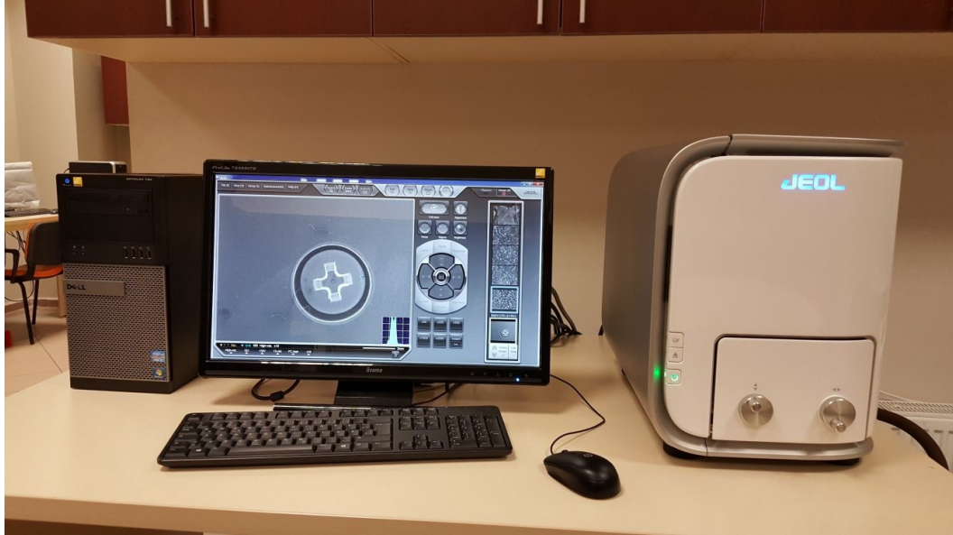
Resim 21. Taramalı Elektron Mikroskobu (SEM) (Jeol JCM 6000 Plus, JEOL, Tokyo, Japonya)
