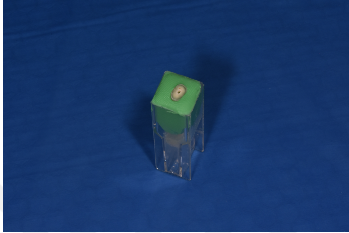
Resim 10. Dişlerin pleksiglas tüp içine yerleştirilen kapalı sistem
