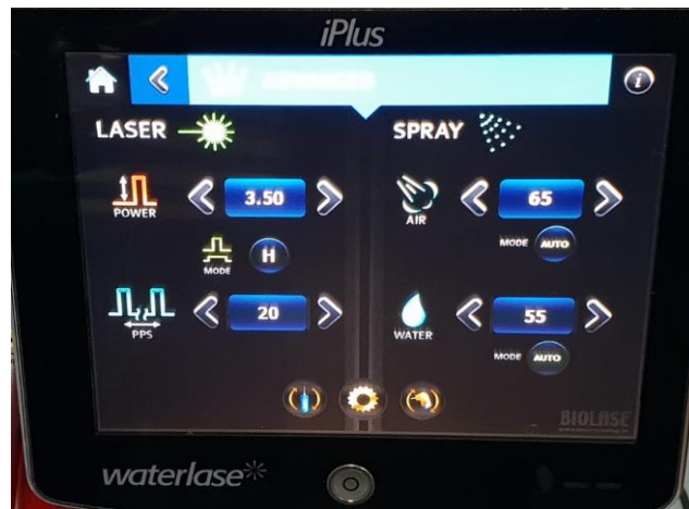
Resim 7. Çalışmamızda kullandığımız lazer cihazının uygulama parametreleri (Waterlase iPlus/MD Gold, Biolase, CA, ABD)
