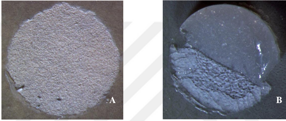
Resim 24. A: PEEK altyapıda adeziv ayrılma (35x büyütme) B: PEEK altyapıda miks ayrılma (35x büyütme)
