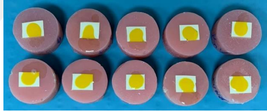
Resim 10. Asit uygulanmış PEEK altyapı örnekleri
