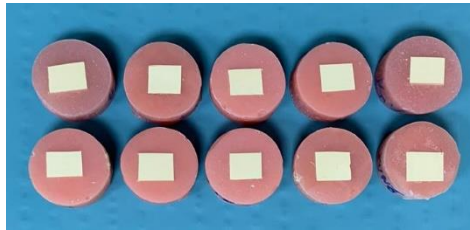
Resim 8. Kontrol grubu PEEK alt yapı örnekleri
