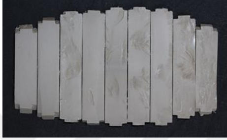
Resim 2. Dikdörtgen şeklinde kesilmiş PEEK bloklar
