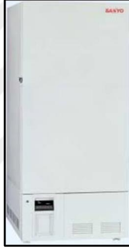
Resim 14. Örneklerin saklandığı -80 C°'lik Soğutucu (Sanyo, MDF-U6086S -86°C Ultra-Low Temperature Freezer, Sanyo Electric Co., Japonya)
