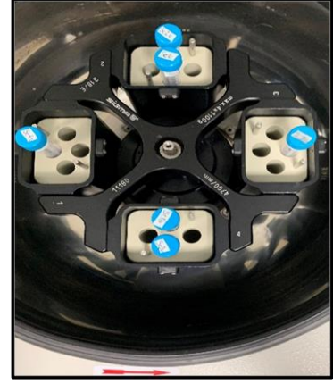
Resim 15. 15 ml'lik tüplerin santrifüj edildiği cihaz [(Sigma 3-18K centrifuge (Sigma, Almanya)]
